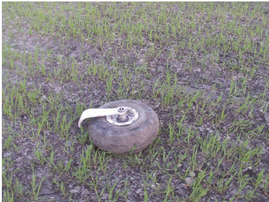
8 –Widok urwanego koła przedniego.
