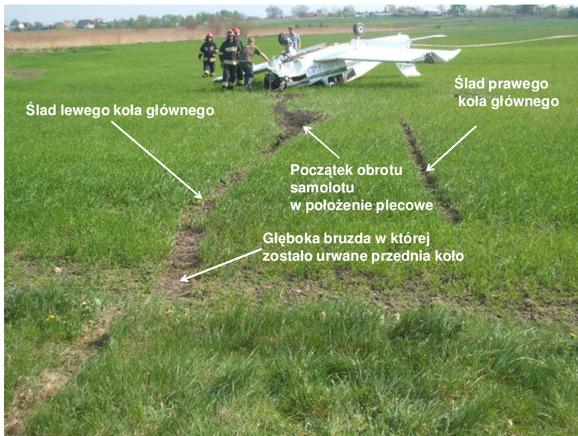
Zdjęcie 4. Głębokie ślady przedniego i prawego koła w miękkim gruncie po wytoczeniu się z roboczej części lotniska.
