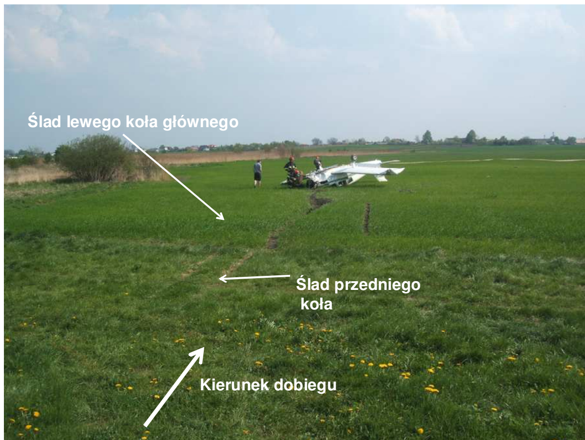
Zdjęcie 3. Ślady przedniego i prawego koła Odległość między śladami (50 cm) świadczy o przemieszczaniu się samolotu z dużym trawersem.
