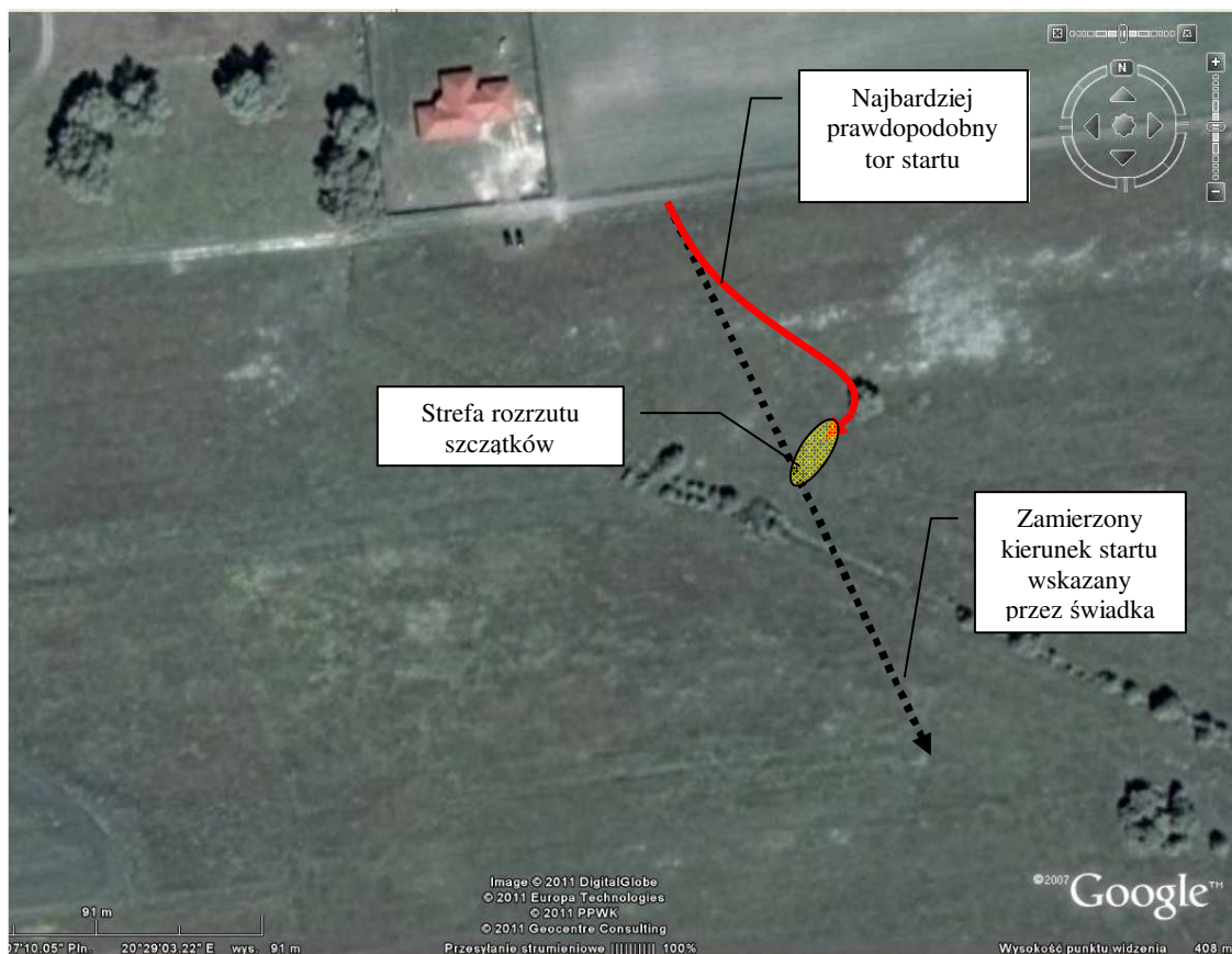
1. Widok miejsca startu z oznaczonym zamierzonym i najbardziej prawdopodobnym przebiegiem startu.
