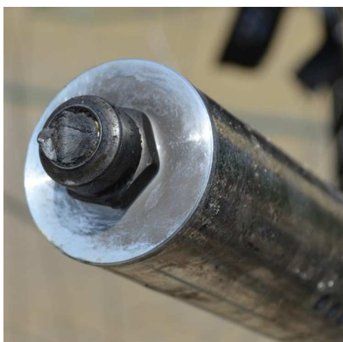
7. Widok przełomów obydwu części półosi prawego koła podwozia. Brak śladów charakterystycznych dla zmęczenia materiału.
