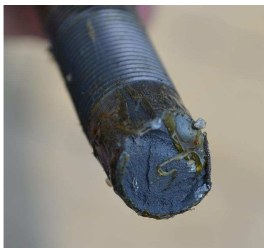
7. Widok przełomów obydwu części półosi prawego koła podwozia. Brak śladów charakterystycznych dla zmęczenia materiału.
