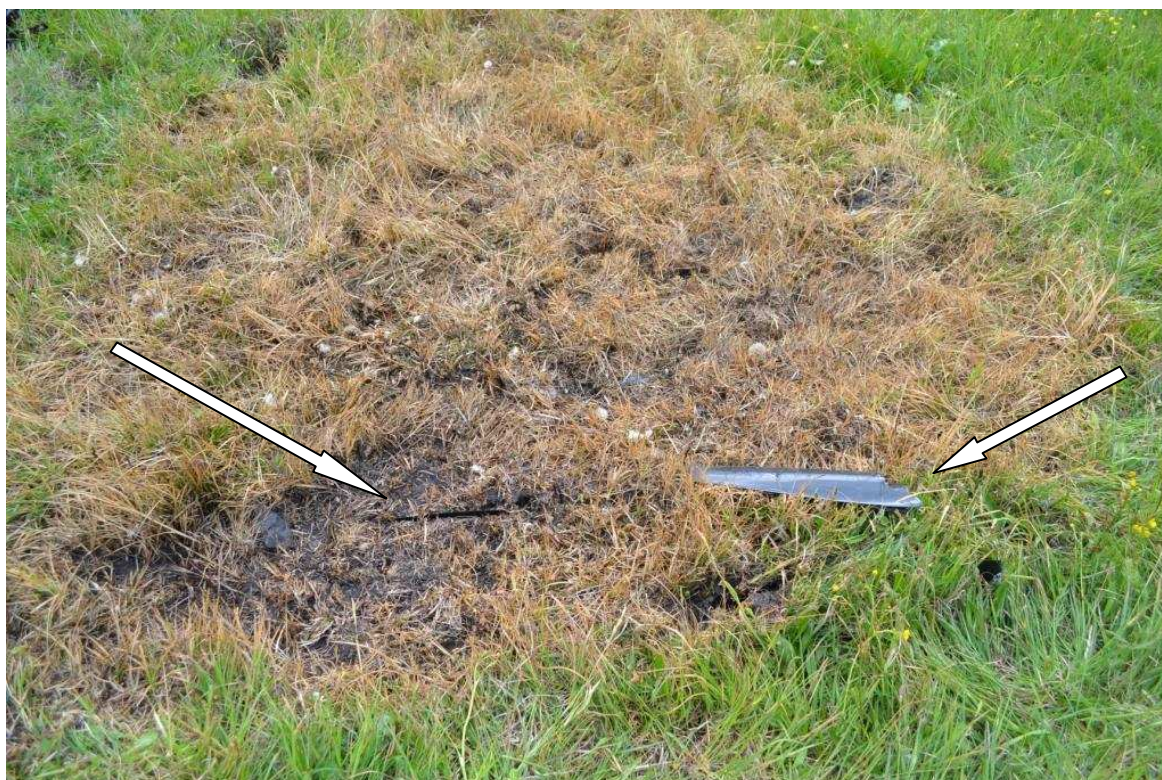
4. Miejsce zderzenia z ziemią. Widok w kierunku 215°. Strzałki wskazują obydwie końcówki łopat śmigła.
