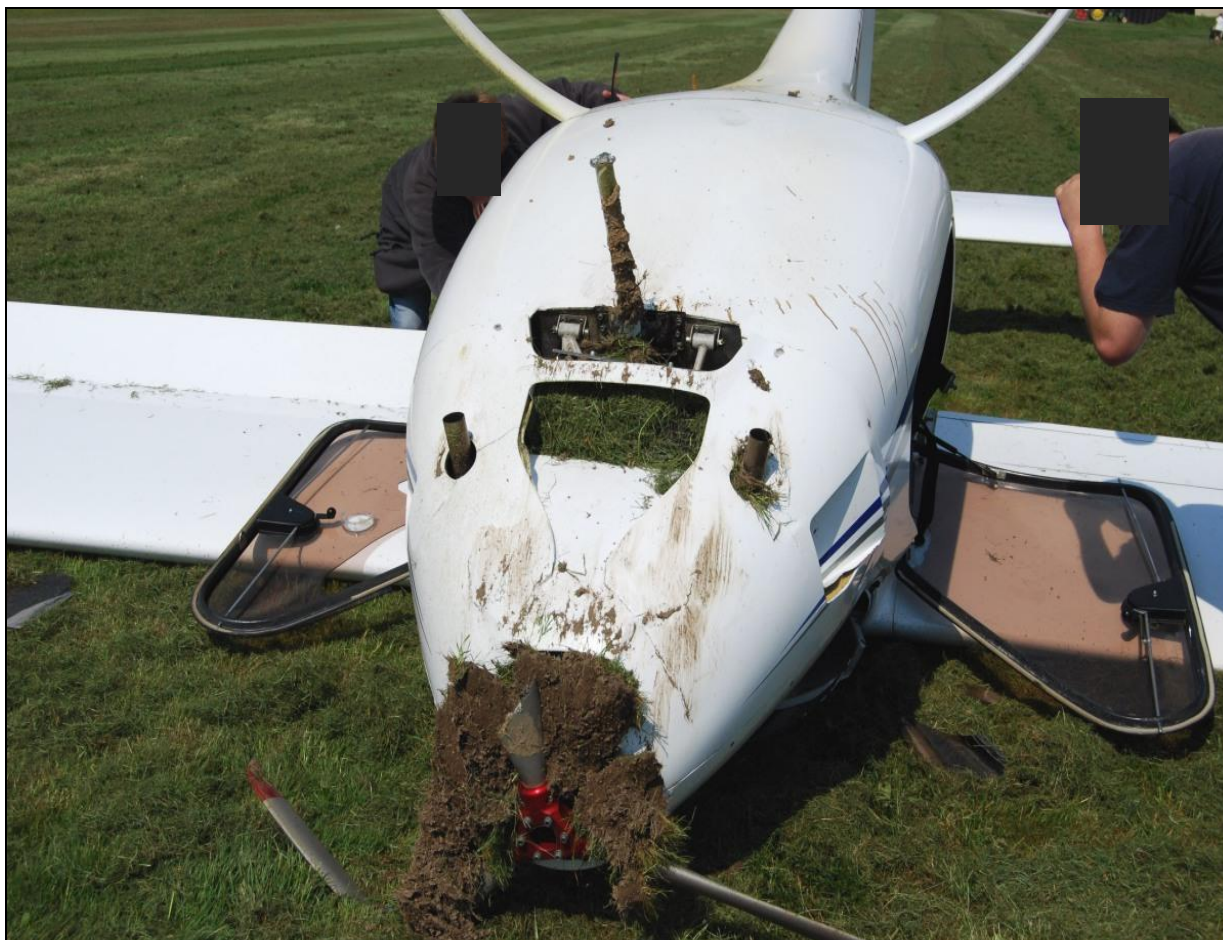
19 – Przednia część samolotu tuż po wypadku – widoczne zniszczone śmigło i złamane podwozie przednie. Obok samolotu odłamki drzwi kabiny [fot.B.Drenda]
