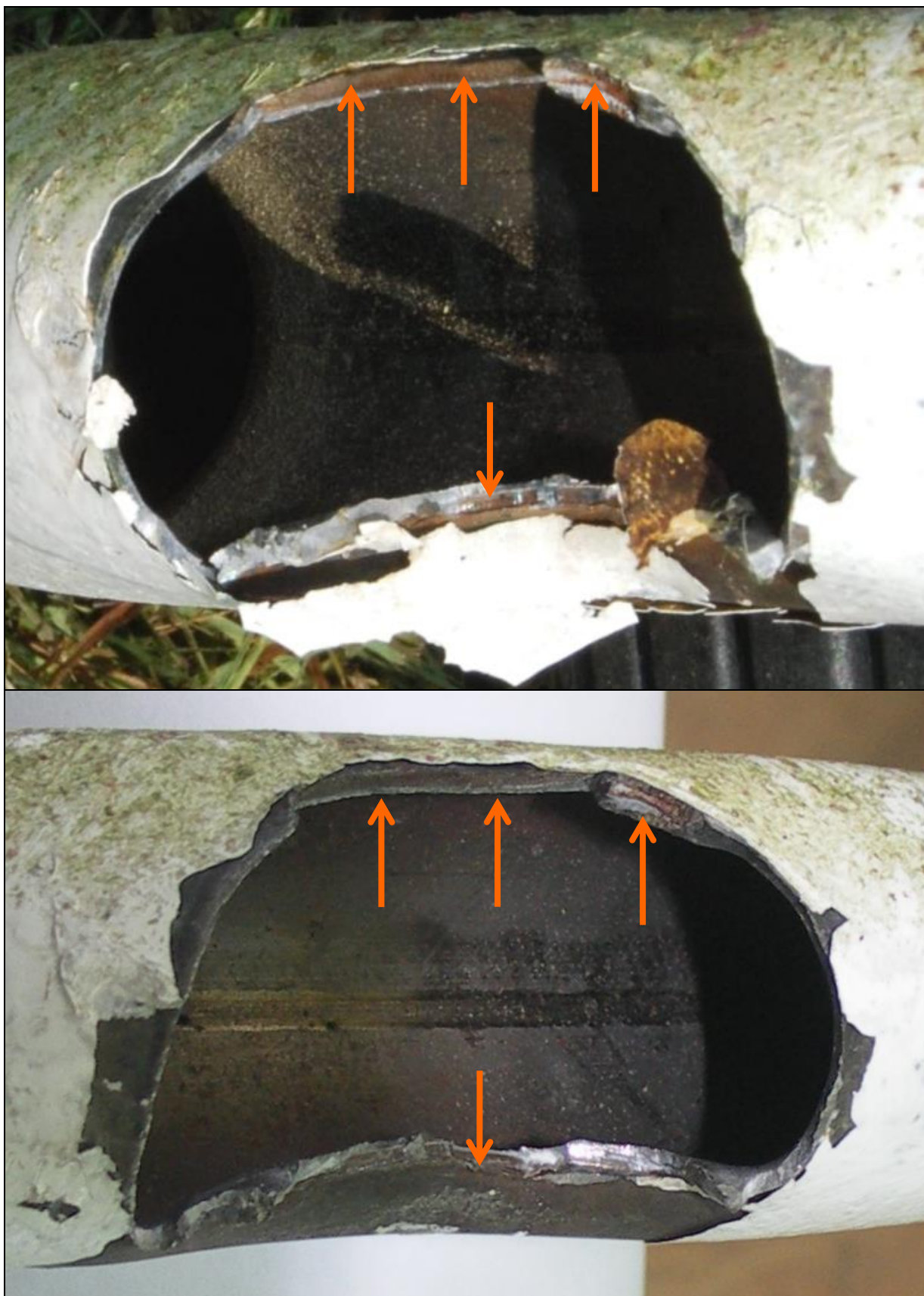
51, 52 – Powiększenia zdjęć 21 i 22, pokazujących przełom na rurze widelca koła podwozia przedniego. Strzałkami pomarańczowymi wskazane ślady korozji, świadczące o niedospawaniu połączenia bądź jego pęknięciu podczas eksploatacji w okresie poprzedzającym wypadek i dłuższej ekspozycji na czynniki korozyjne. Wyraźnie widać szew na dnie rury – dowód na użycie do budowy widelca z niezgodnego z dokumentacją materiału (właściwe rury wykonane ze stali 30HGSA występują jedynie w wersji ciagnionej) [fot.B.Drenda i PKBWL]
