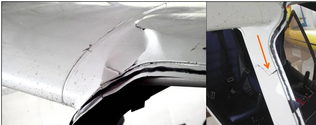
34 – Górne pokrycie kadłuba u nasady prawego skrzydła, zniszczone w wyniku kapotażu.
