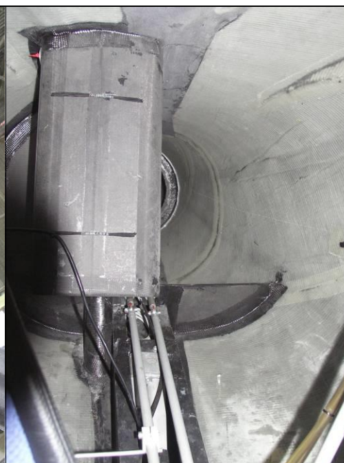
40 – Wnętrze tylnej części kadłuba. Widoczne popychacze sterowania i zasobnik spadochronowego systemu ratowniczego GRS.
