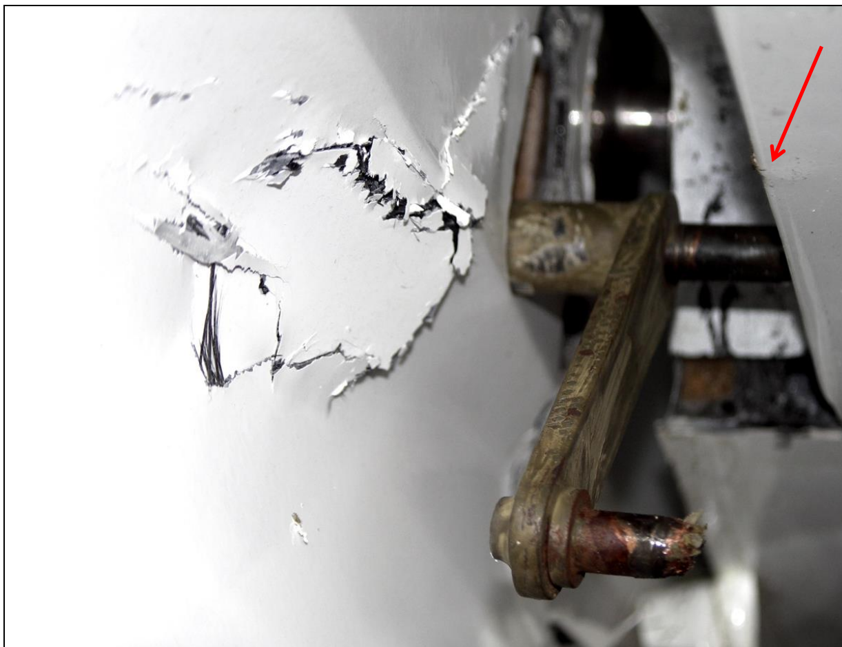
38 – Zbliżenie na korbę odłączonego napędu prawej kłapy, widok od tyłu. Widoczne uszkodzenia kadłuba. Wygląd kłapy w miejscu wskazanym strzałką świadczy o jej uszkodzeniu podczas gwałtownego rozłączenia napędu wskutek wypadku.
