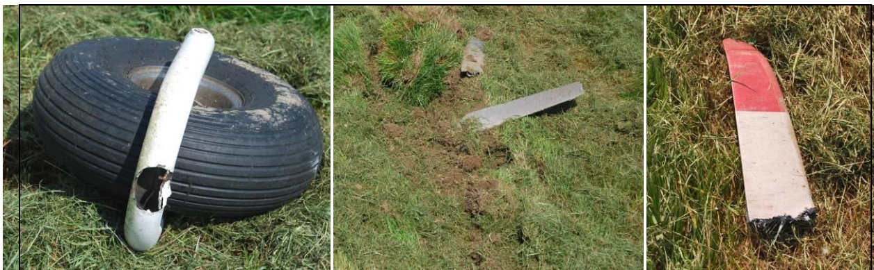
13, 14, 15 – Oderwany od goleni widelec przedniego podwozia z kołem oraz szczątki łopaty śmigła. [fot.B.Drenda]
