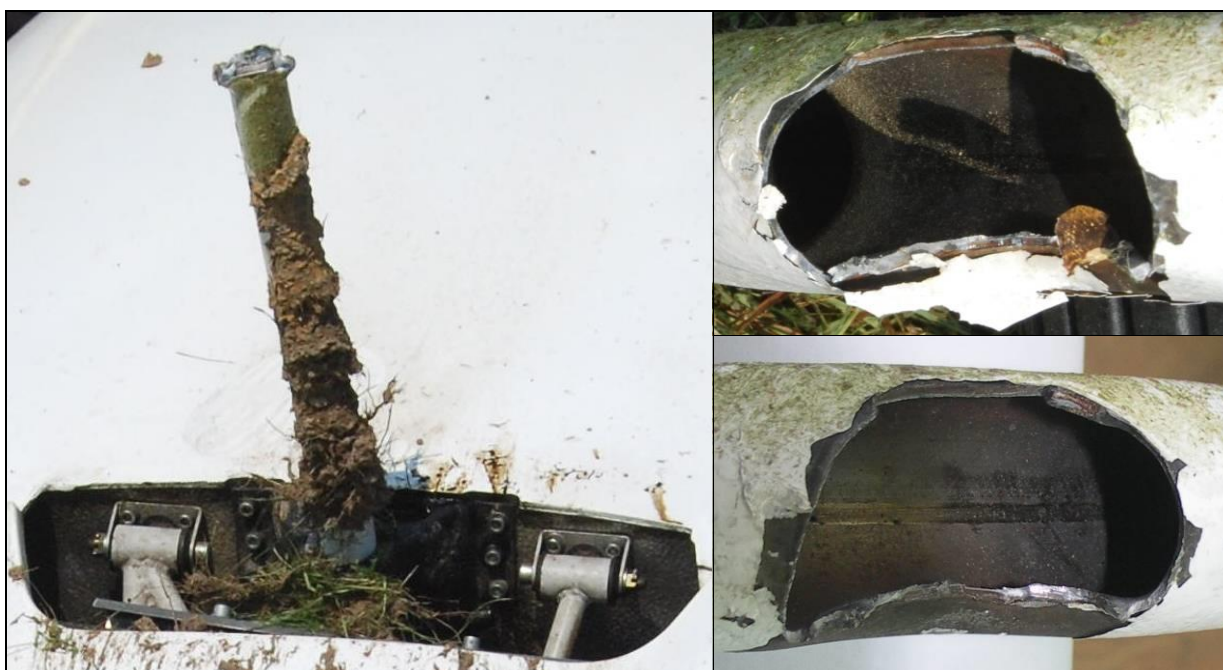
20, 21, 22 – Goleń podwozia przedniego z odłamanym widelcem, po prawej dwa zbliżenia przełomu na rurze odłamanego widelca koła. Wyraźnie widać szew na dnie rury – dowód na użycie do budowy widelca z niezgodnego z dokumentacją materiału (właściwe rury wykonane ze stali 30HGSA występują jedynie w wersji ciągnionej) [fot.B.Drenda]
