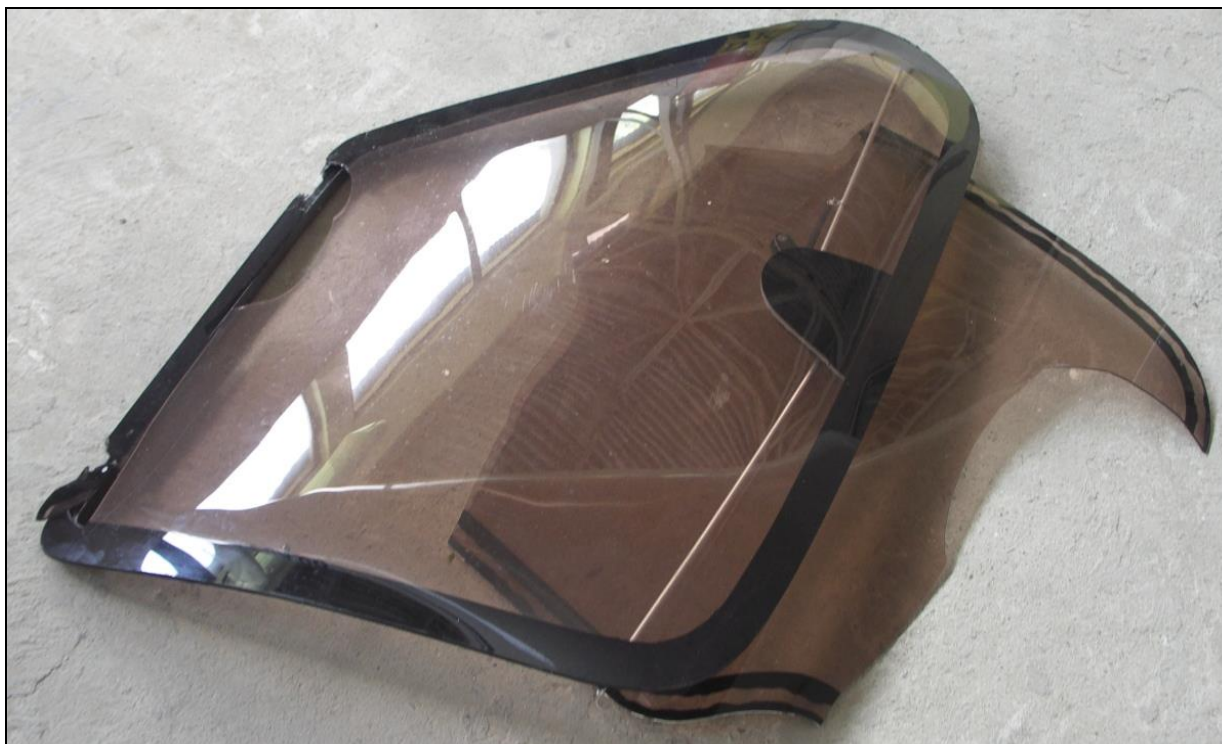
46 – Zniszczone lewe drzwi kabiny (na wierzchu) i fragment szyby przedniej kabiny (pod spodem).
