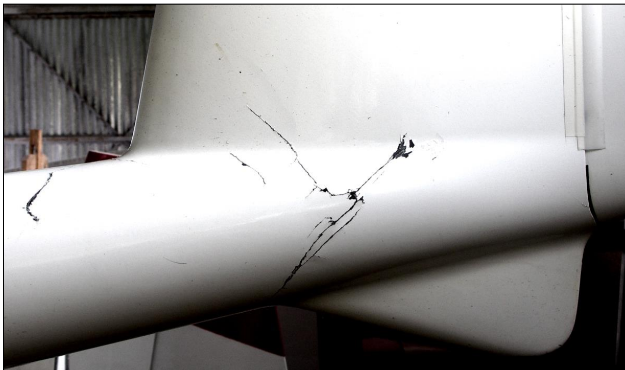
41 – Uszkodzenia (pęknięcia) pokrycia belki ogonowej u nasady statecznika pionowego, lewa strona kadłuba.
