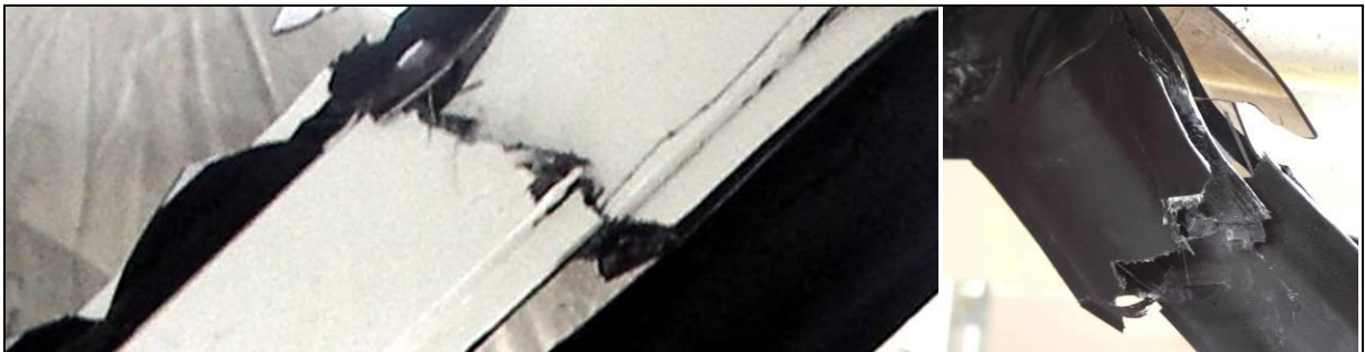
30, 31 – Pęknięcie zniszczonej przedniej wręgi kabiny po lewej stronie, pokazany od zewnątrz (po lewej) i od wewnątrz kabiny (po prawej).
