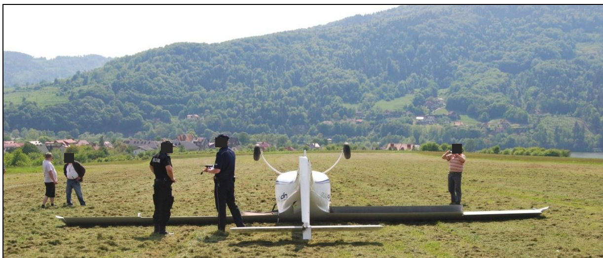
16 – Samolot na miejscu wypadku, widok w kierunku przeciwnym do kierunku podejścia do lądowania. Zwraca uwagę asymetryczne położenie kłap skrzydłowych. [fot.B.Drenda]
