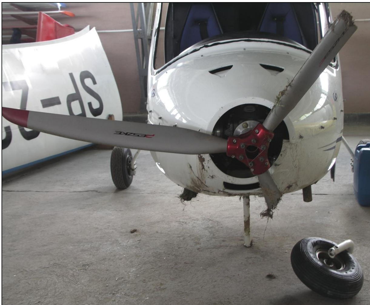
25 – Samolot po wypadku w hangarze. Widoczne zniszczone śmigło i podwozie przednie, obok odłamany widelec podwozia przedniego z kołem.
