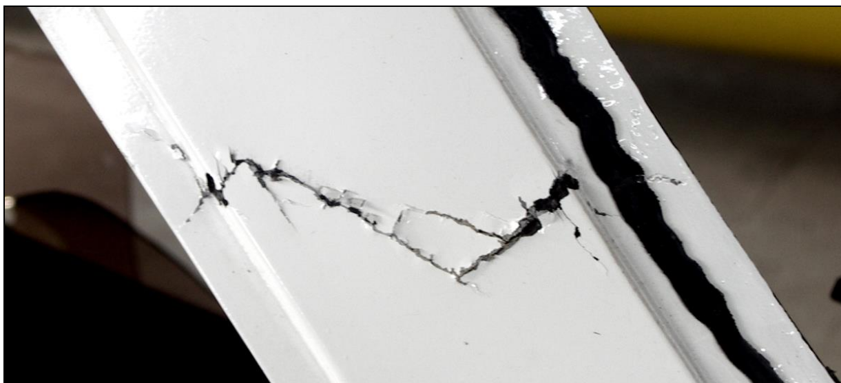
36 – Pęknięcie zniszczonej przedniej wręgi kabiny po prawej stronie – zbliżenie fragmentu zdjęcia 35.
