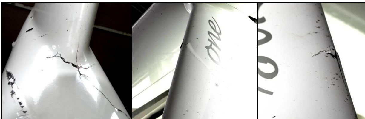
43 – Pęknięcia i rozklejenia struktury na grzbiecie belki ogonowej u nasady statecznika pionowego.
