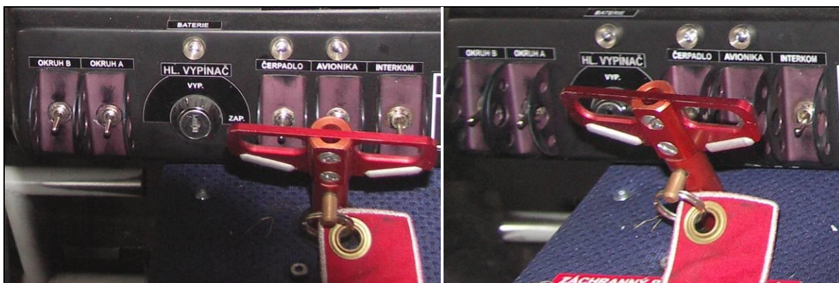
47, 48 – Widok na centralny pulpit przełączników instalacji elektrycznej i uchwyt aktywowania spadochronowego systemu ratowniczego GRS. Widoczne położenia przełączników instalacji elektrycznej i włożona zawleczka zabezpieczająca uchwyt aktywacji systemu GRS.
