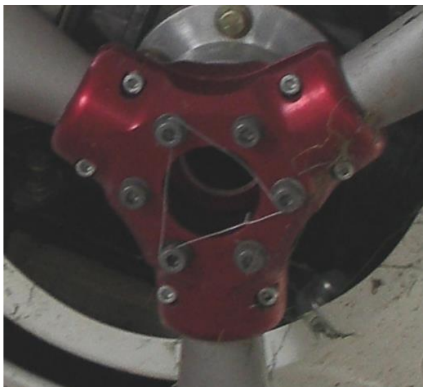
Rys.6 Niezgodne z zaleceniami producenta zabezpieczenie śrub mocujących śmigło do kołnierza wału silnika – po prawej rysunek z instrukcji śmigła, pokazujący prawidłowe zabezpieczenie wszystkich sześciu śrub (sworzni)
