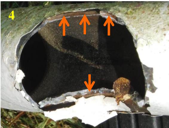
Rys.3 Zdjęcia pokazujące: 1 - podwozie przedniego samolotu przed wypadkiem; 2 – trzon goleni podwozia przedniego z odlamanym widelcem; 3 – oderwany od goleni widelec podwozia przedniego z kołem; 4, 5 – dwa zbliżenia przelomu na rurze odlamanego widelca koła podwozia przedniego (strzałkami wskazane ślady korozji oraz wyraźnie widać szew na dnie rury; właściwe rury ze stali 30HGSA występują jedynie w wersji ciągniętej)
