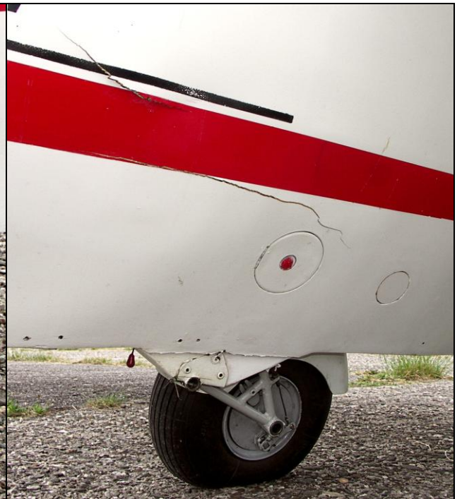
2. Lewa strona kadłuba – pęknięcia pokrycia w rejonie mocowania podwozia.
