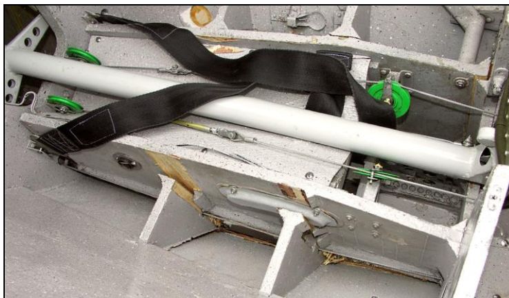
3. Wnętrze kadłuba – widoczne uszkodzenia pod tylnym fotelem.
