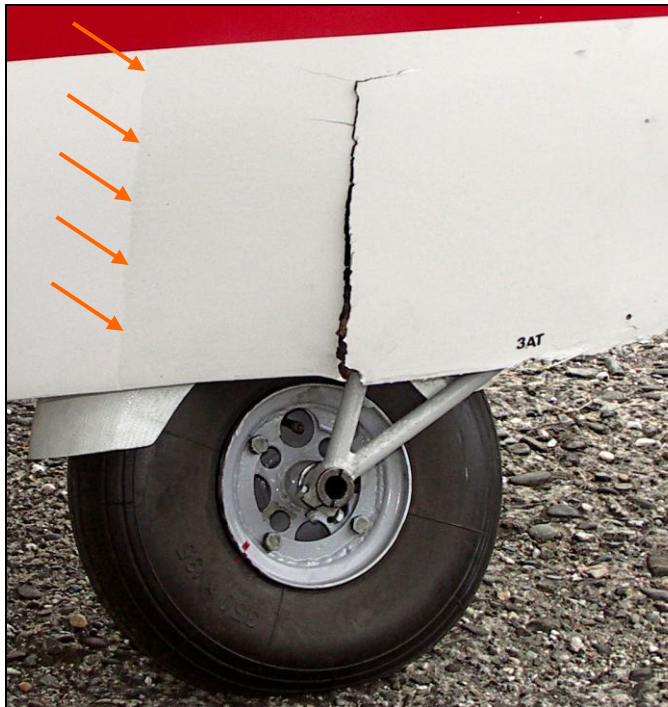
1. Prawa strona kadłuba – pęknięcie i nadłamanie pokrycia (wskazane strzałkami) w rejonie mocowania podwozia.
