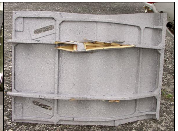
4. Siedzisko tylnego fotela – widoczne uszkodzenia.
