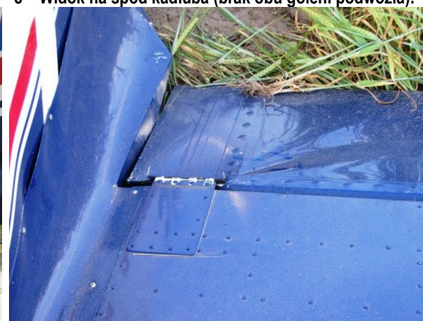
10 – Uszkodzona kłapa na lewym skrzydle.
