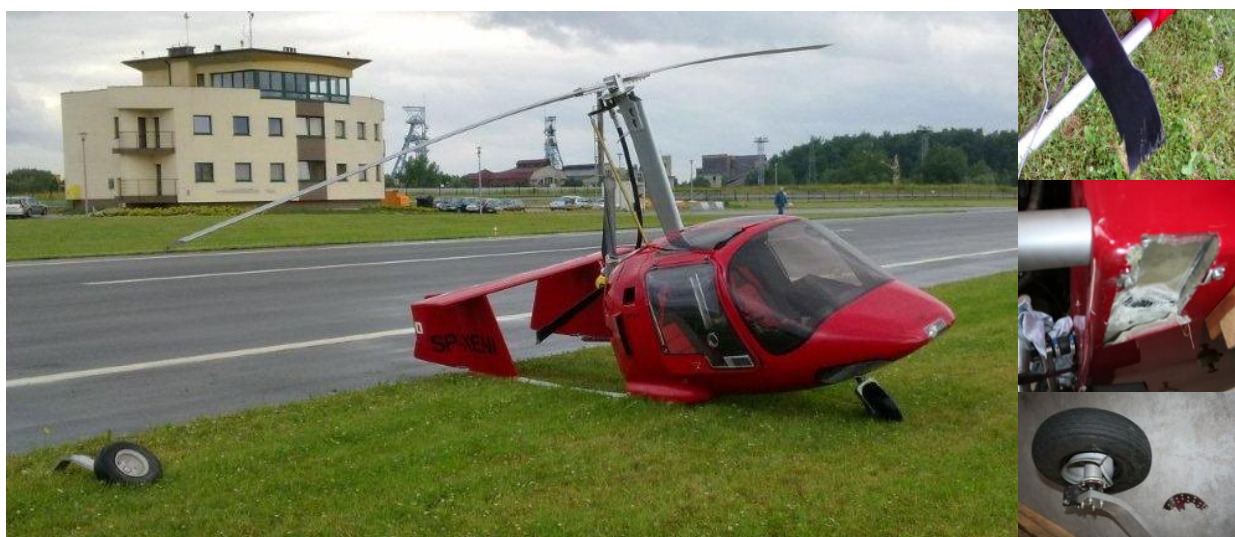
Foto 2. Wiatrakowiec na miejscu zdarzenia – widoczne uszkodzenia podwozia i śmigła pchającego [zdjęcia użytkownika]
