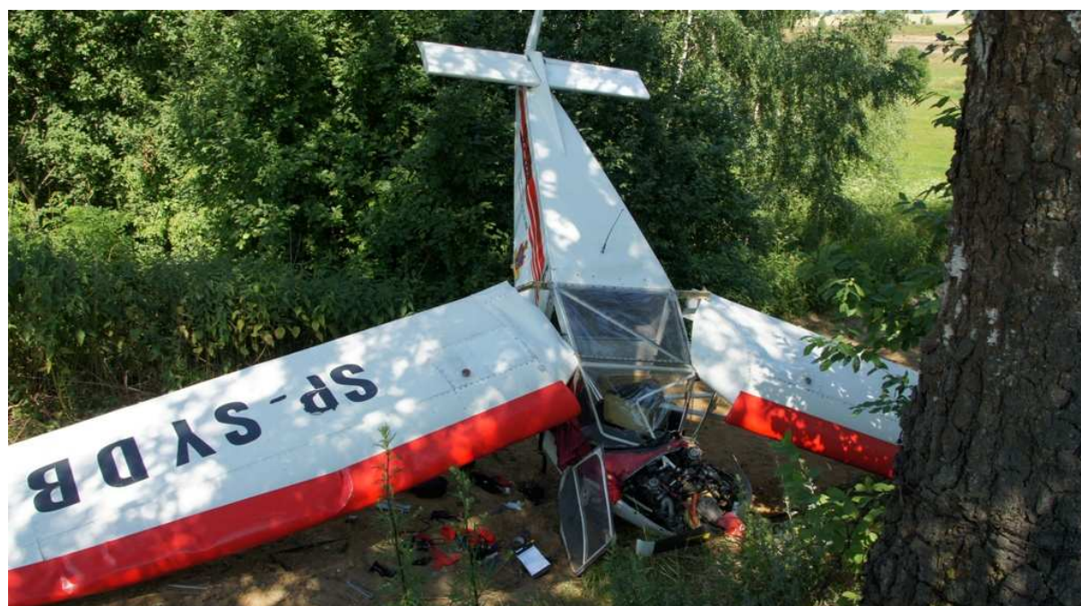
10 – Dobrze widoczna zniszczona konstrukcja samolotu [foto: PKBWL]
