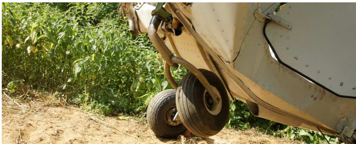
13 – Zgięta goleń podwozia przedniego [foto: PKBWL]
