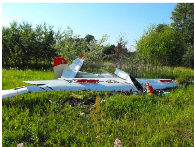
Rys.3 Widok na wrak szybowca z przodu z prawej strony. Widoczne wysunięte płyty hamulców aerodynamicznych.
