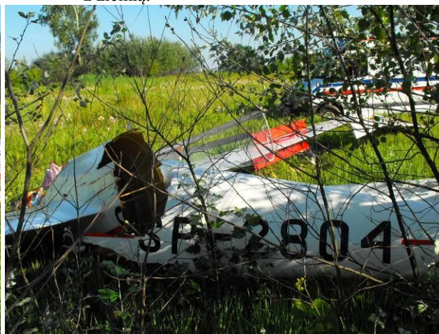
Rys. 12 Widok na przelamany kadłub.
