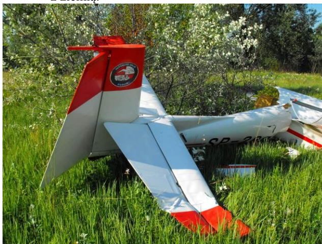
Rys. 11 Widok na ułamany tył kadłuba.
