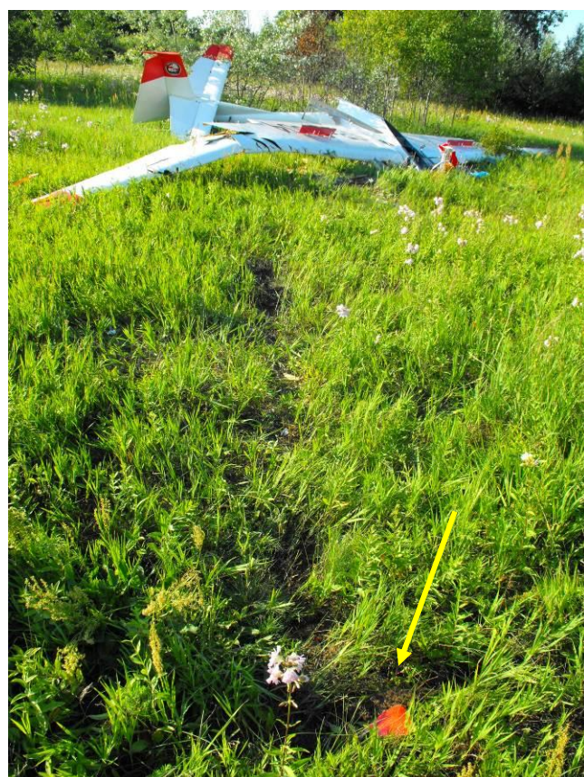
Rys. 8 . Widok na miejsce uderzenia prawym skrzydłem o ziemię - strzałka pokazuje element, który odpadł od skrzydła
