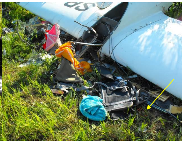
Rys. 16 Rozpuszczony spadochron ratowniczy. Strzałka pokazuje wyciągnięty uchwyt wyzwalający.
