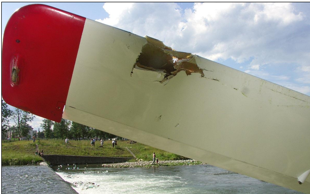
12 – Uszkodzenia prawego skrzydła od spodu.
