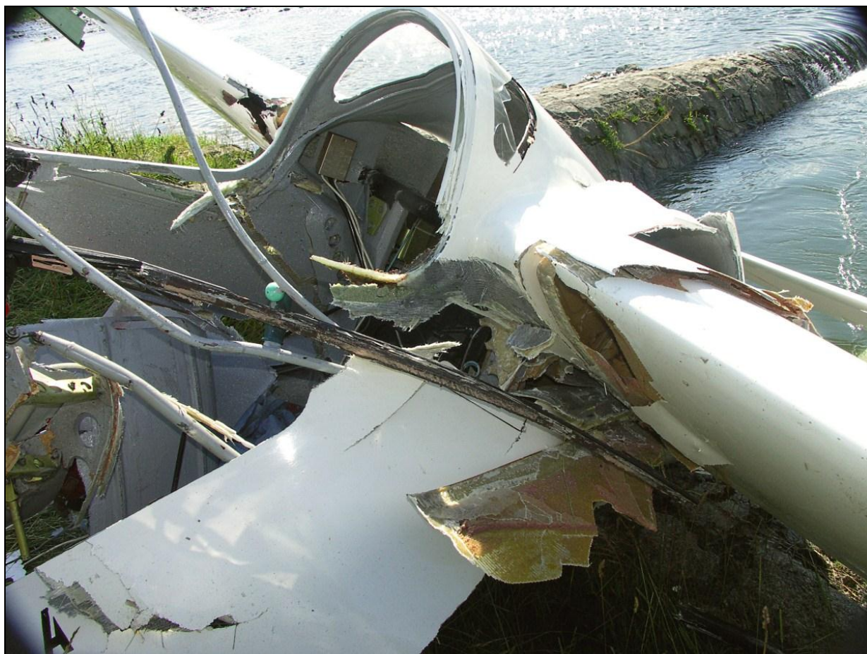
11 – Zbliżenie na środkową część kadłuba szybowca – widoczne zniszczenia.
