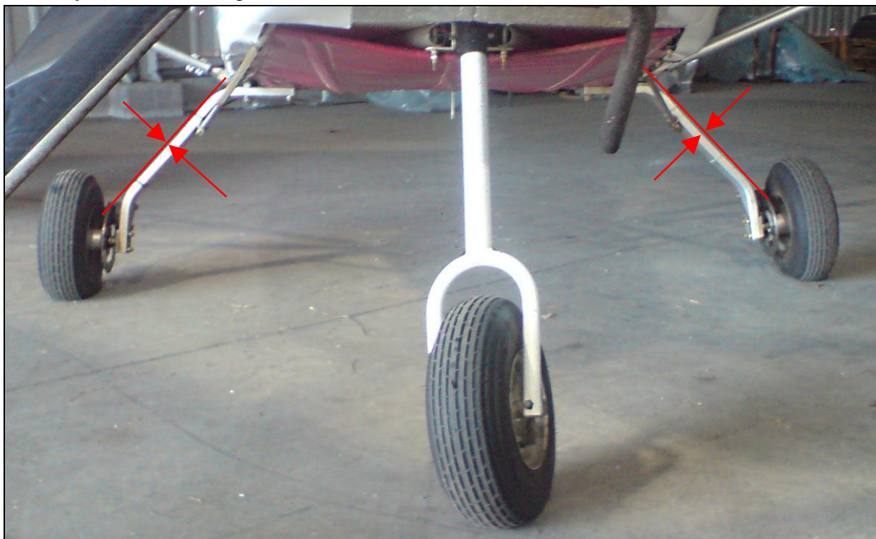
Zdjęcie uszkodzonego podwozia, wykonane po skołowaniu do hangaru.
