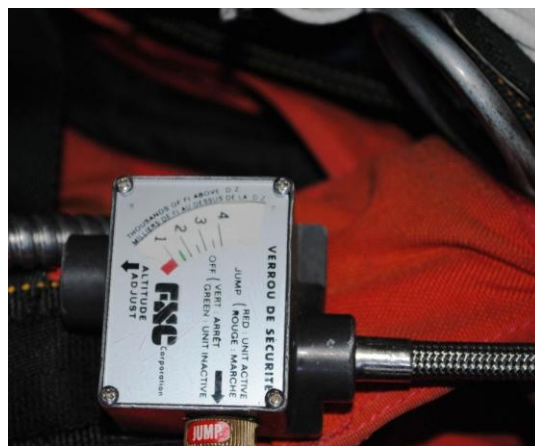
Fot.2 Moduł nastawiania wysokości automatu FXC 12000. Zielona wskazówka ustawiona na 1500 ft. (fot. Policja)
