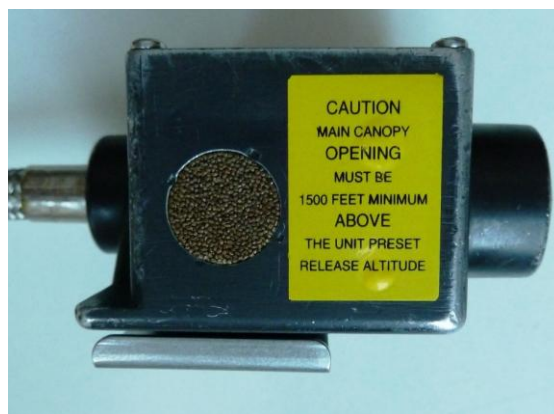
Fot. 6. Naklejka na module nastawiania wysokości. Widoczny tekst przestrogi w języku angielskim. (Fot. PKBWL)
