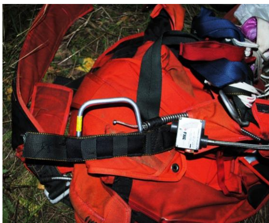
Fot.1 pokrowiec / uprząż z widocznym uchwytem wyzwalania czaszy zapasowej. (fot. Policja)
