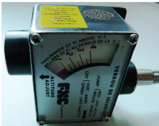
Fot. 5. Moduł nastawiania wysokości zadziałania. Na jednej z bocznych ścianek (obok filtra) widoczna jest żółta naklejka. (Fot. PKBWL)
