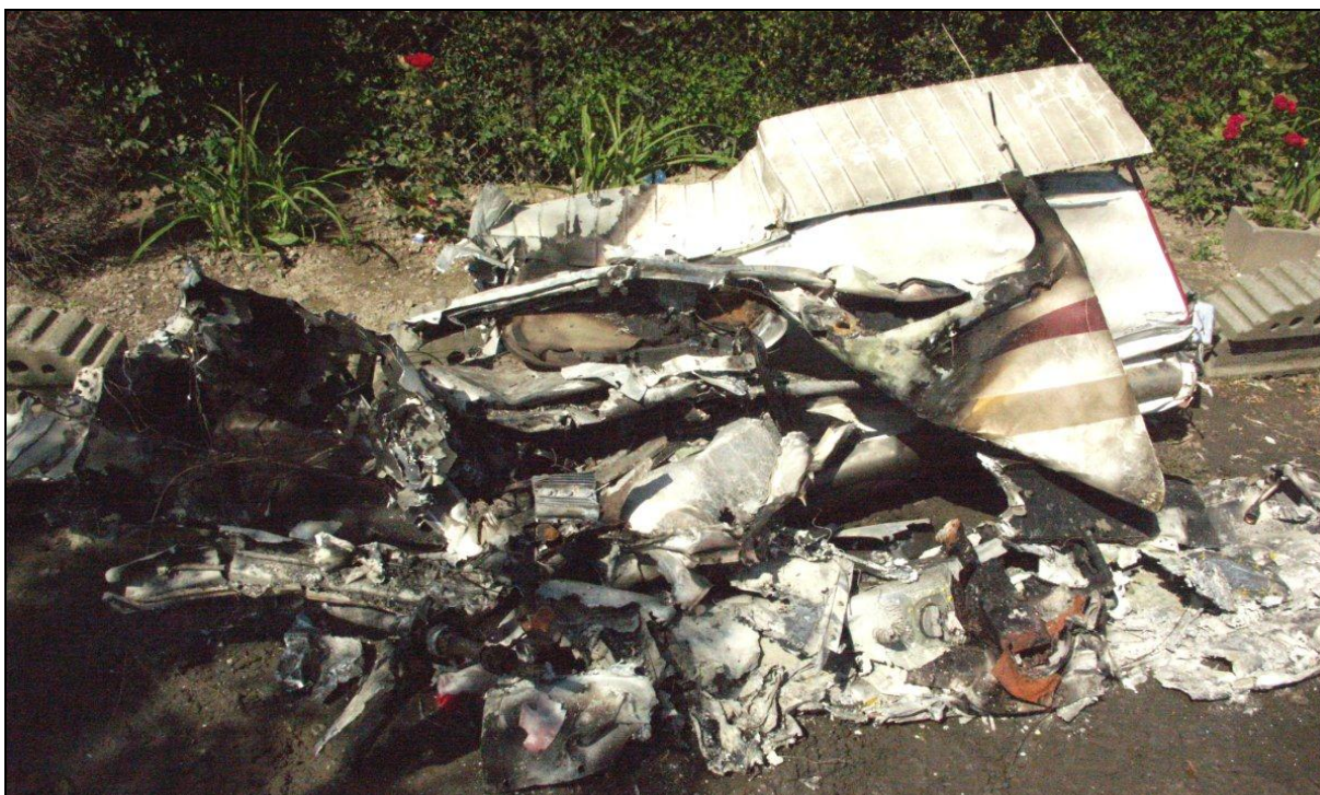
35 – Szczątki prawego skrzydła, zebrane z miejsca wypadku.
