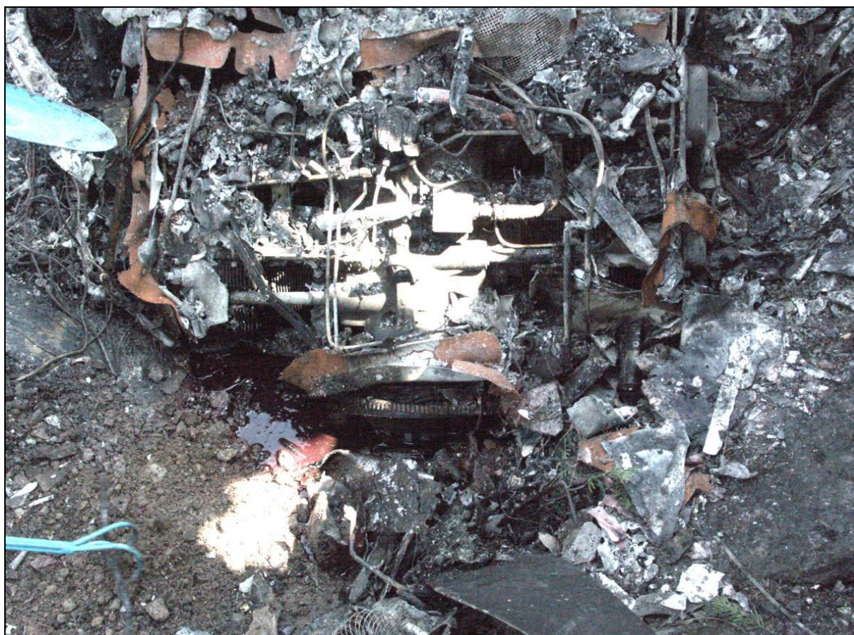
32 – Przednia część silnika i jedna z łopat śmigła, wystająca z gruntu w miejscu zderzenia z ziemią. Widoczna kałuża oleju silnikowego.
