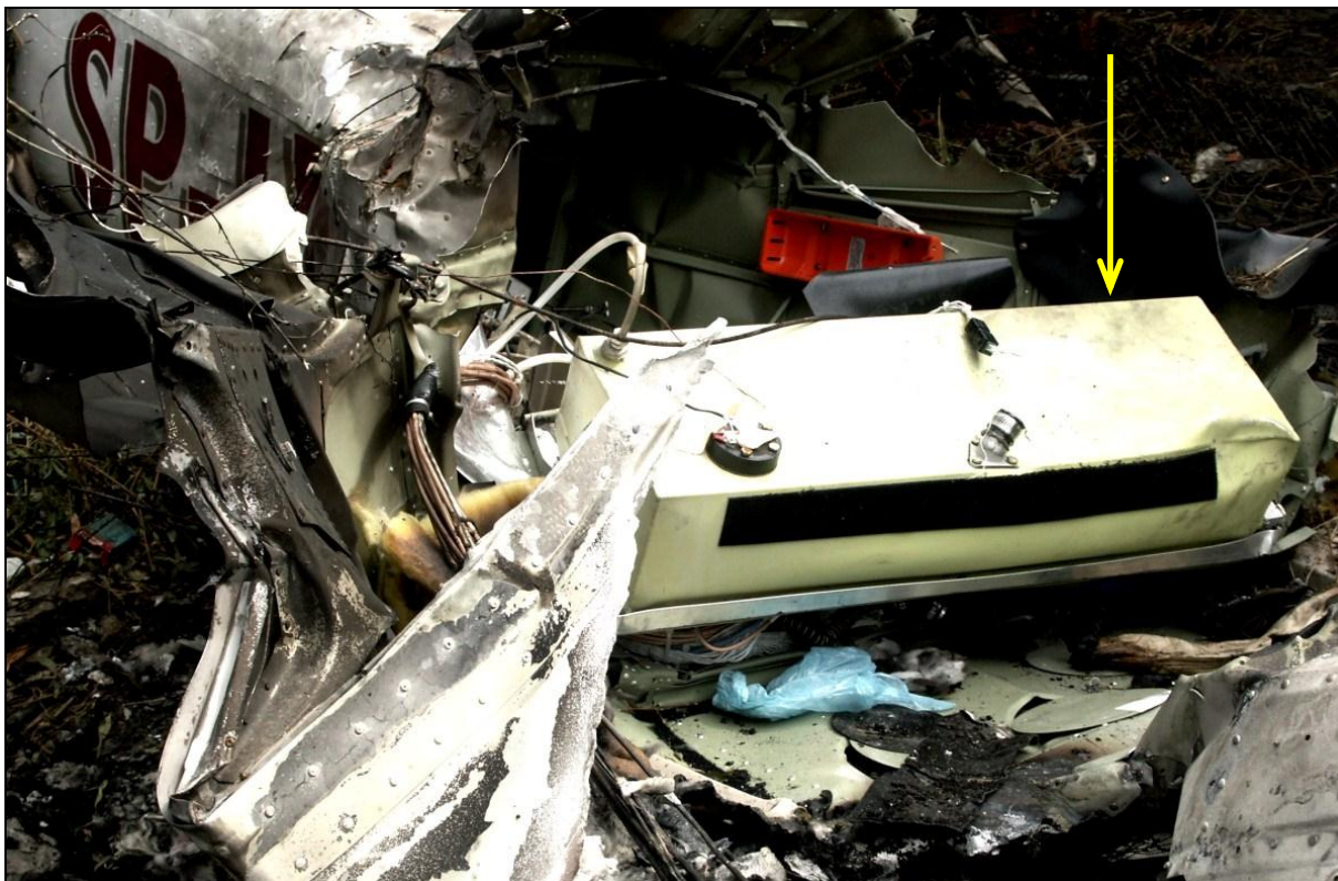
22 – Wnętrze tylnej części kadłuba. Strzałką żółtą zaznaczono zbiornik płynu instalacji przeciwbłodzeniowej.
