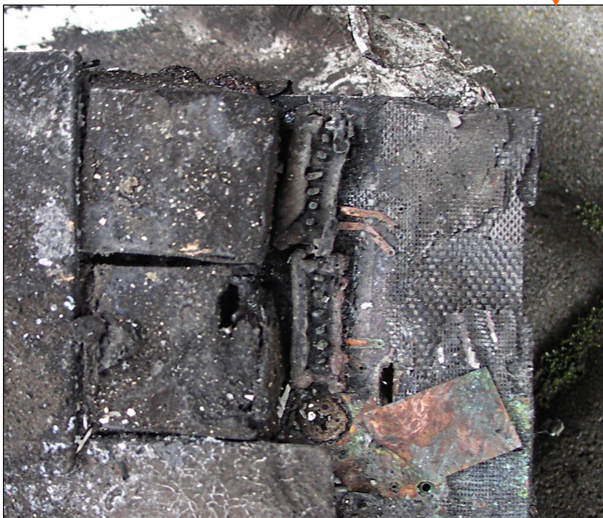
26 – Powiększony fragment z gniazdami kart pamięci – widoczne całkowite zniszczenie gniazd i brak kart.
