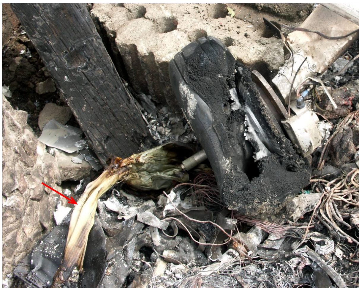
30 – Koło prawego podwozia głównego z częściowo spalonym ogumieniem, obok niego wskazany strzałką fragment nadpalonej poduszki powietrznej (airbag) pasów bezpieczeństwa.
