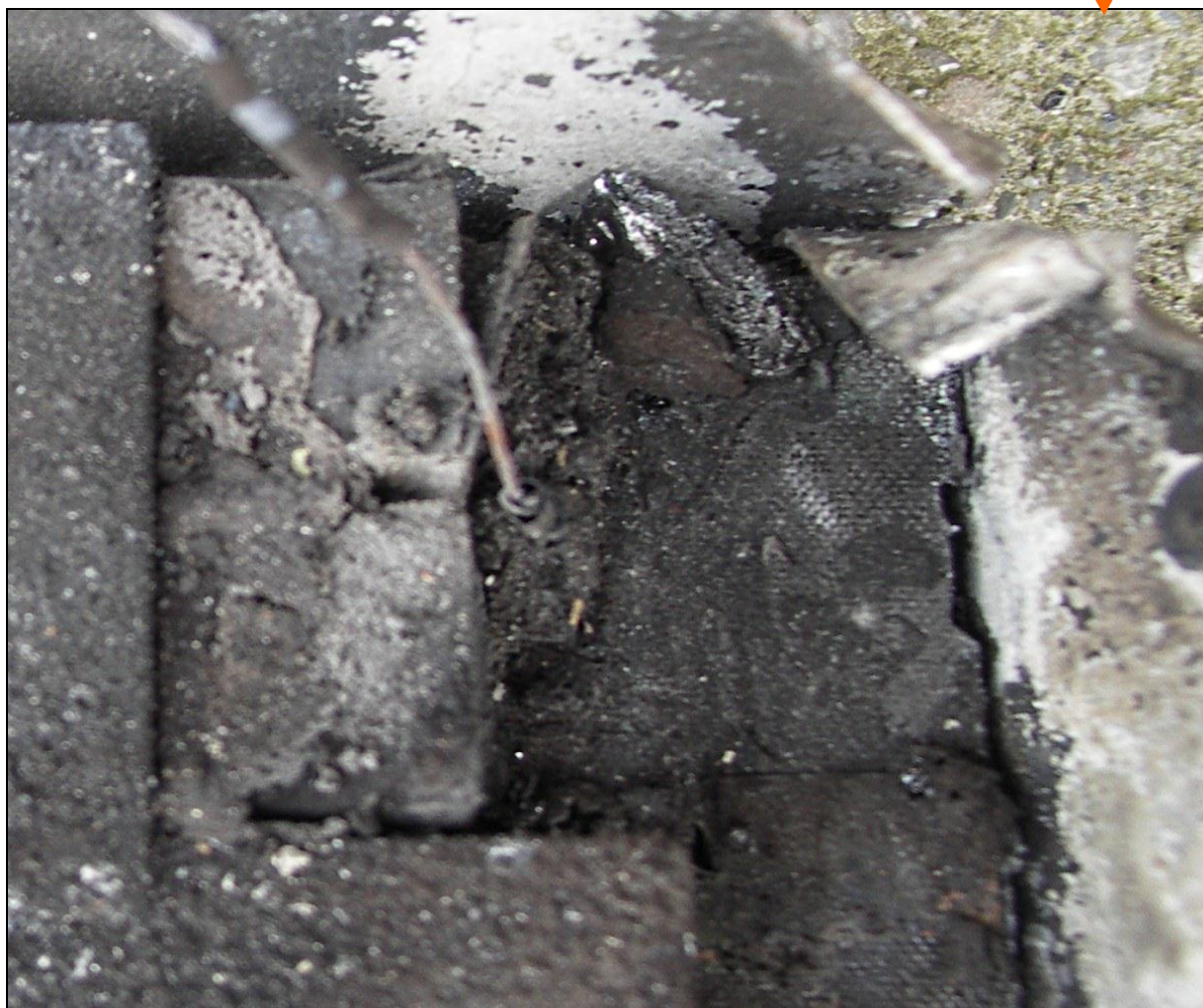
28 – Powiększony fragment z gniazdami kart pamięci – widoczne całkowite zniszczenie gniazd i brak kart.
