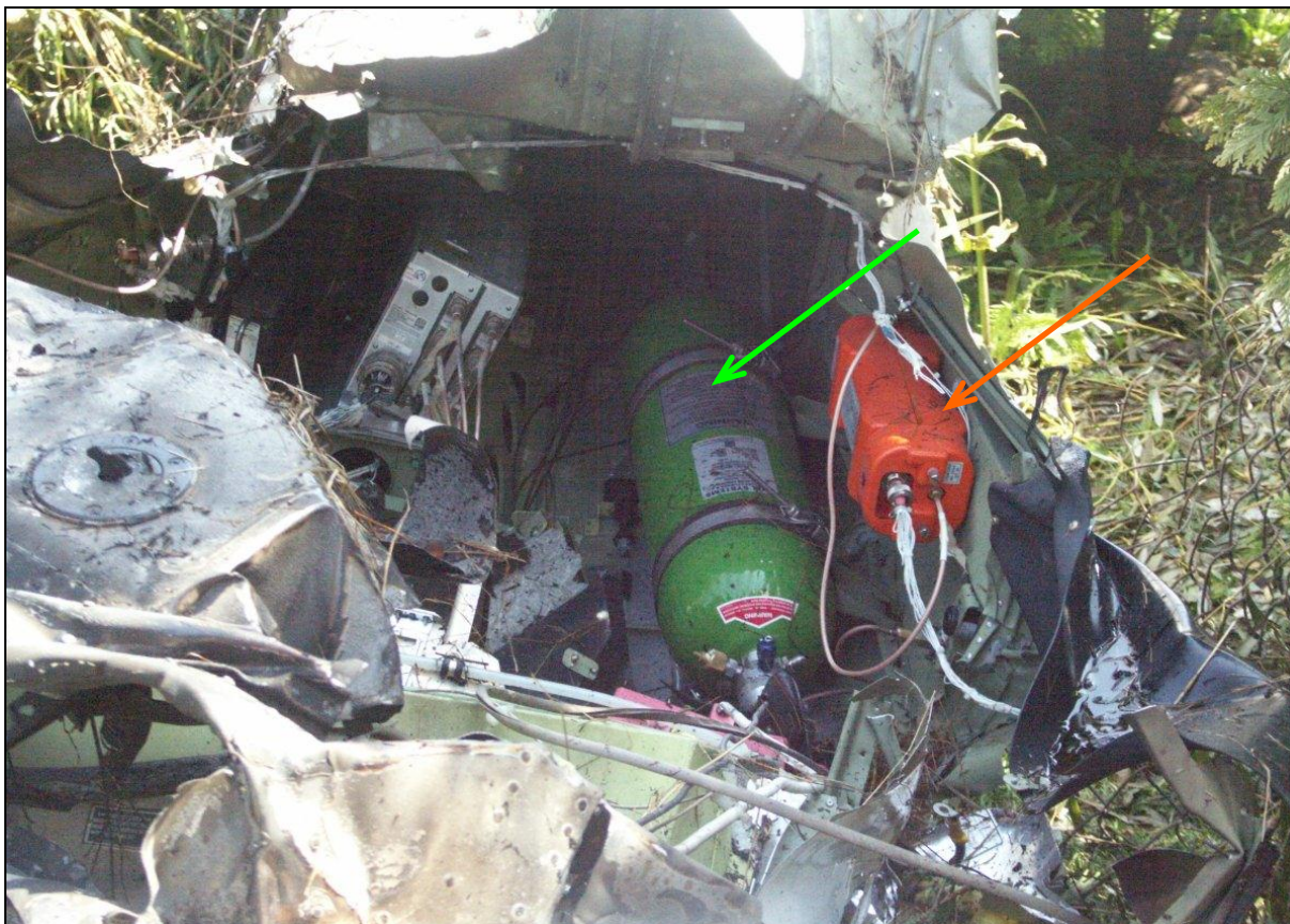
21 – Wnętrze tylnej części kadłuba. Strzałką zieloną zaznaczono butlę instalacji tlenowej, strzałką pomarańczową – nadajnik ELT.
