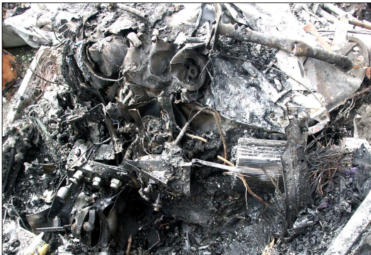
24 – Wypalone szczątki tablicy przyrządów.
