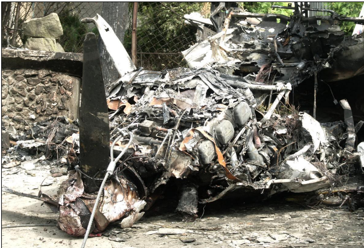
33 – Silnik po wydobyciu z gruntu. Widoczne dwie łopaty śmigła i spłaszczony nosek kołpaka śmigła.
