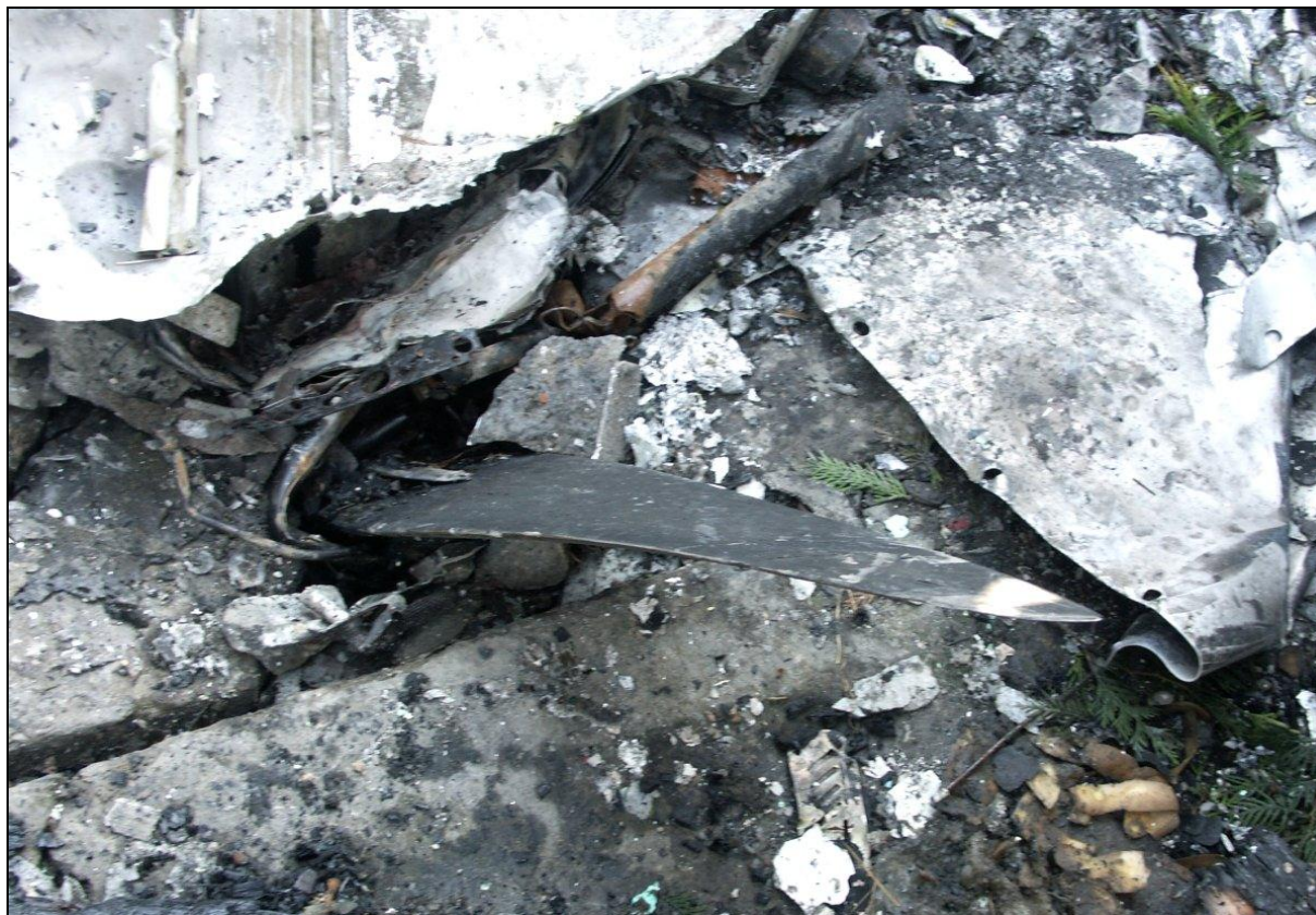
31 – Jedna z łopat śmigła, wystająca z gruntu w miejscu zderzenia z ziemią.
