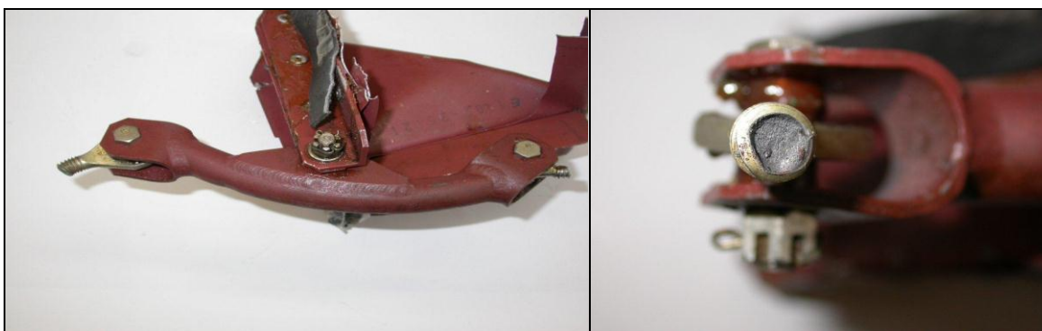
Dwuramienna dźwignia pośrednia w układzie sterowania sterem wysokości ze złamaną śrubą końcówki regulacyjnej popychacza tylnego.
