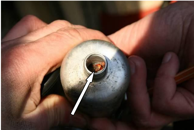
Foto 13. Widoczny czerwony silikon w integralnym filtrze pompy paliwowej
