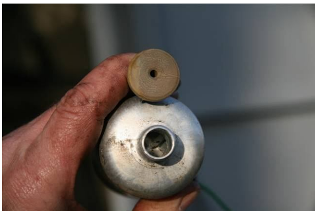
Foto 12. Porównanie średnicy króćca ssącego pompy paliwa do najwyższego miejsca w instalacji - króćca poboru paliwa w zbiorniku
