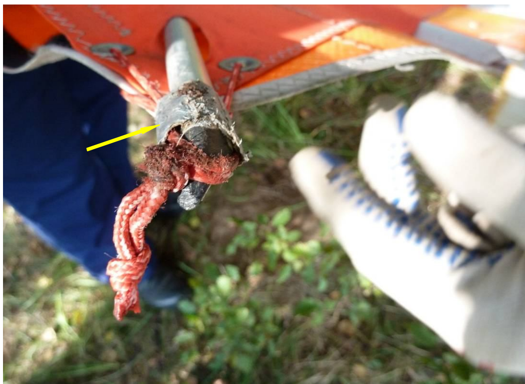
Foto 8. Sznurek naciągowy poszycia, zabezpieczony przed zsunięciem przez oklejenie taśmą
