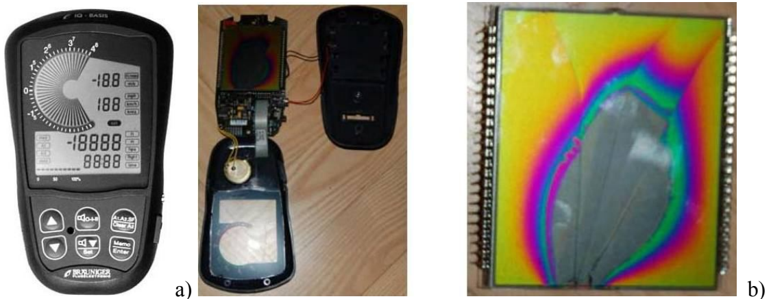
Rys 2. Urządzenie Brauniger IQ-COMFORT, a) widok ogólny, b) uszkodzone w wyniku wypadku motolotni
