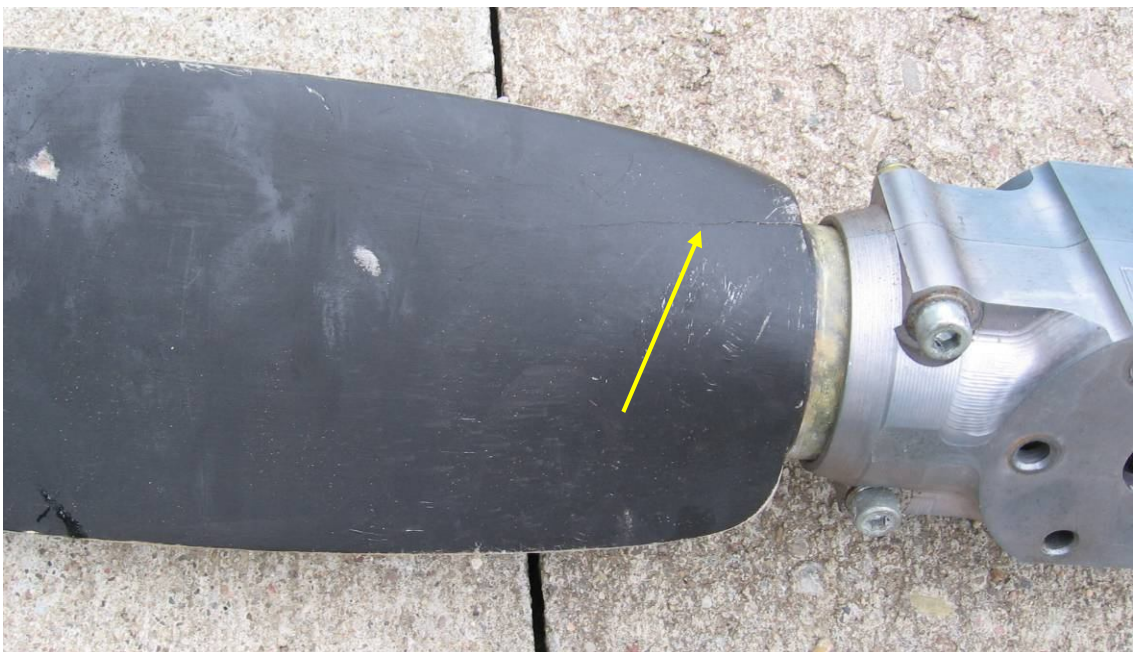
Foto 21. Ślad uszkodzenia nasady piasty śmigła
