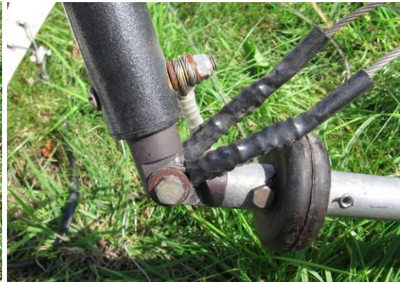
Foto 10. Ślady korozji w elementach lewego węzła bocznego sterownicy
