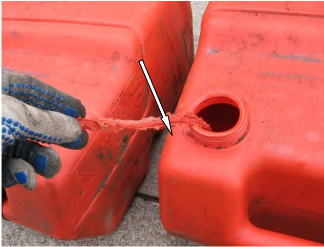
Foto 15. Fragmenty silikonu stwierdzone w lewym zbiorniku paliwowym
