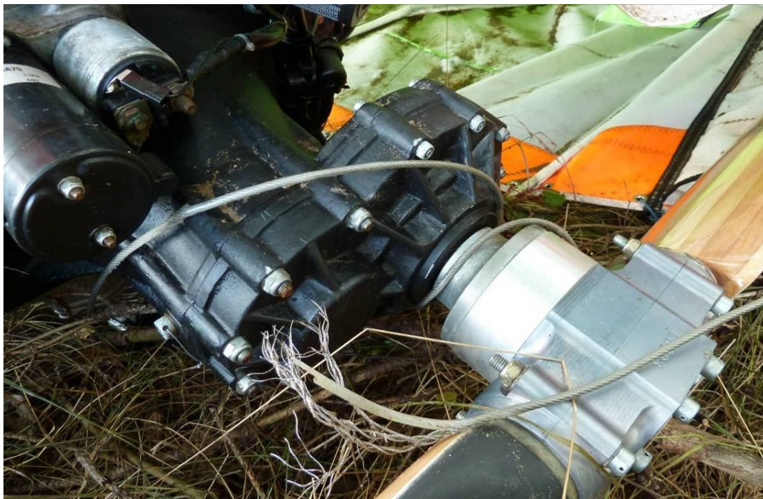
Foto 5. Zerwana linka, nawinięta na korpusie przekładni i wale śmigła
