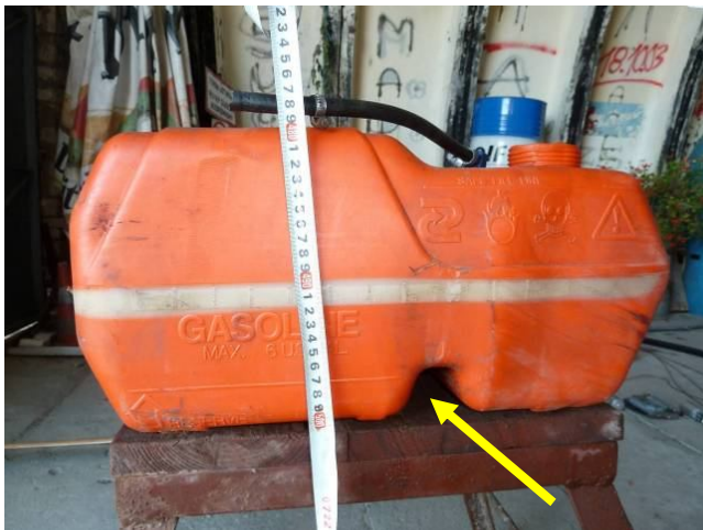
Foto 22. Prawy zbiornik paliwa motolotni z zaznaczonym charakterystycznym wgłębieniem, służącym do montażu
