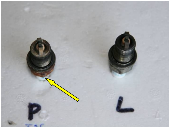
Foto 16. Świece zapłonowe po wykręceniu, na świecy P widoczne ślady korozji
