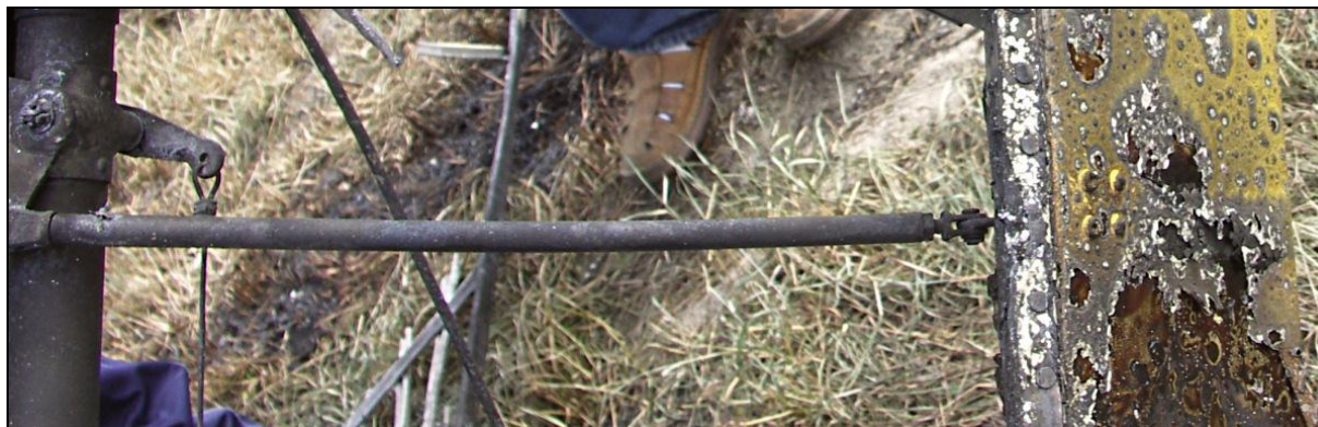
20 – Sterowanie klapką wyważającą steru wysokości – zachowana ciągłość kinematyczna.
