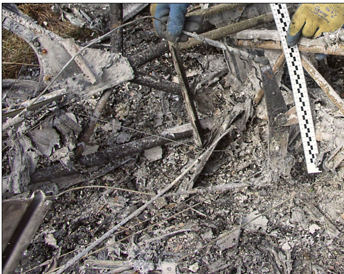
19 – Linki i dźwignia układu sterowania sterem wysokości w kadłubie – zachowana ciągłość linek.
