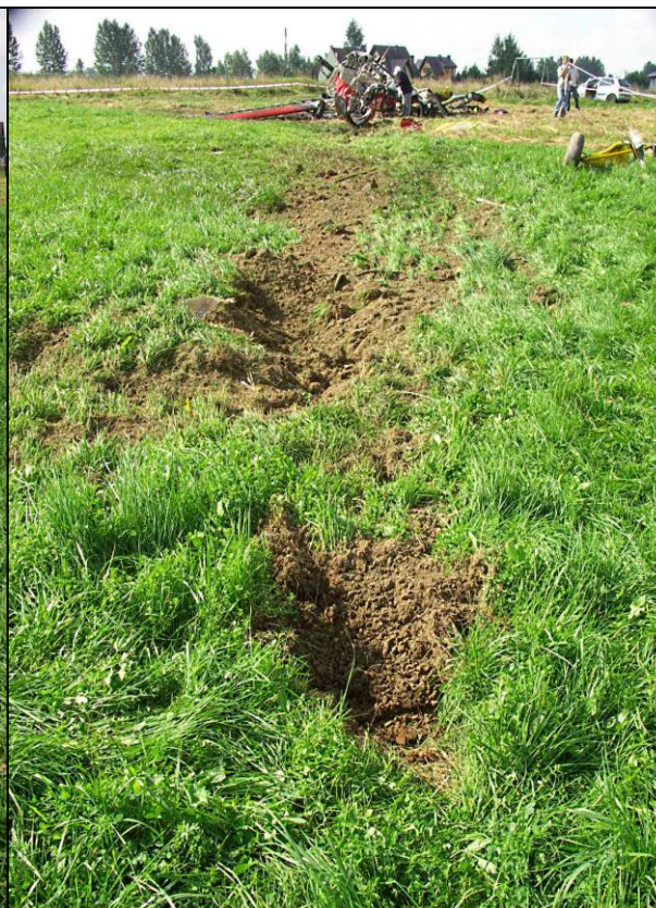
9 – Końcowa część śladu samolotu na ziemi (po zmianie kierunku wskutek zarycia i odłamania lewego podwozia głównego).
