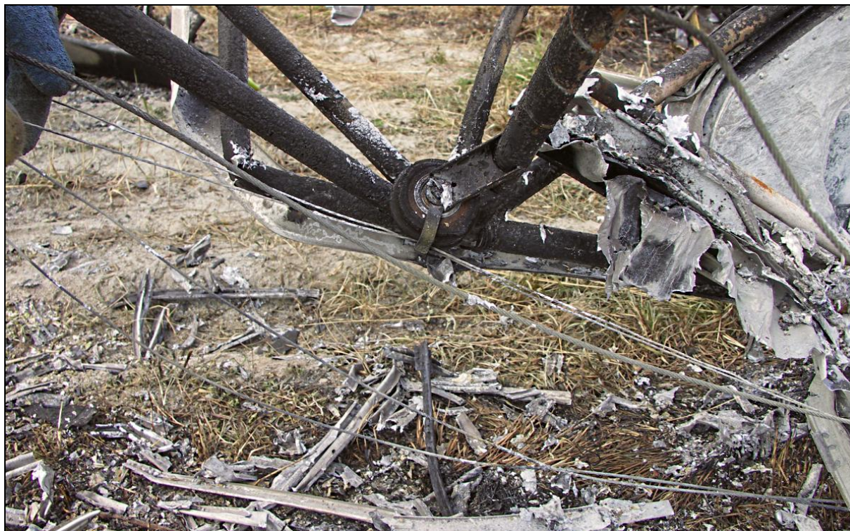
18 – Zespoły linek układów sterowania płatowncem w kadłubie – zachowana ciągłość linek.
