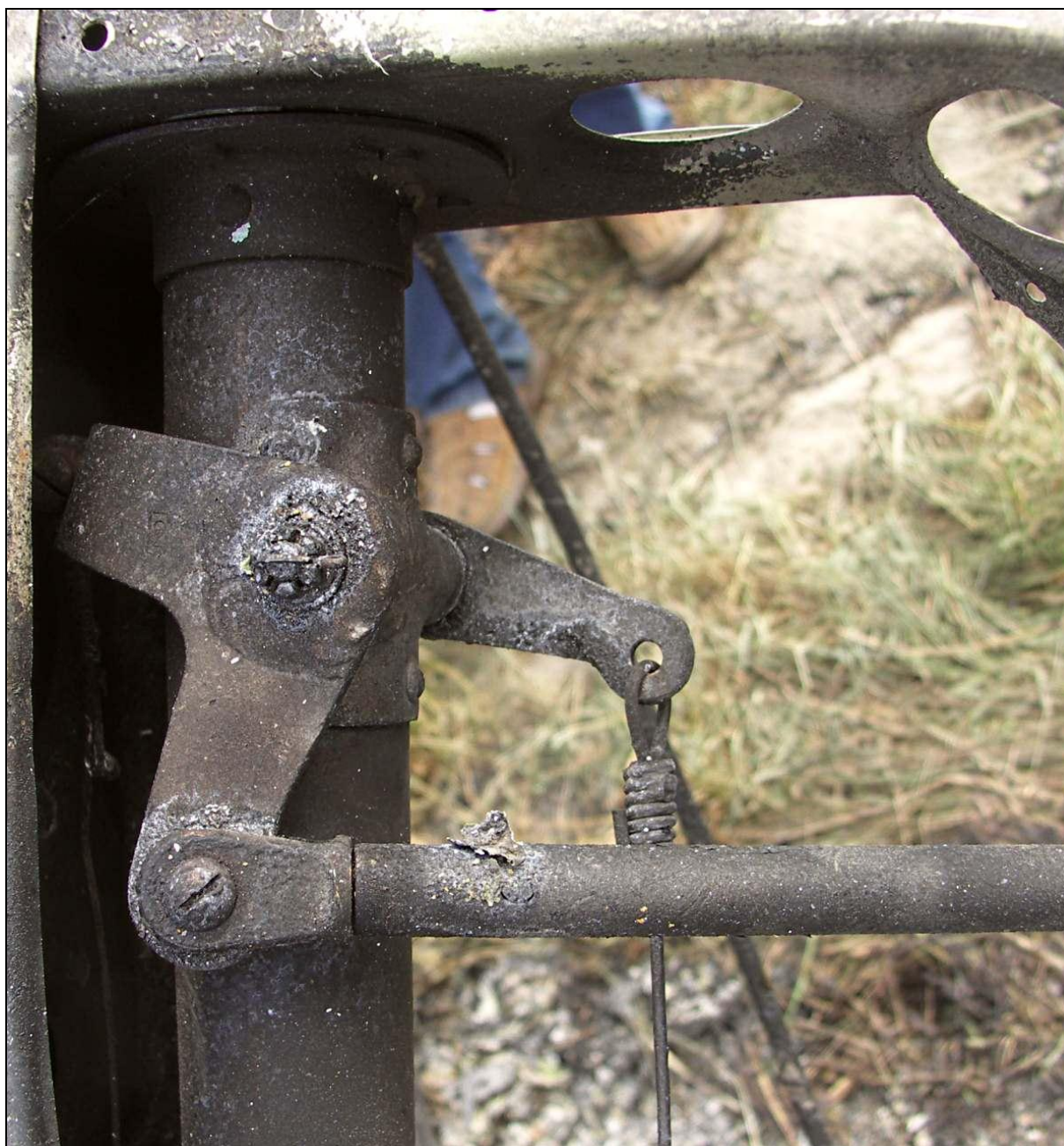
21 – Sterowanie klapką wyważającą steru wysokości – zbliżenie dźwigni przekazującej napęd z linek na popychacz klapki.
