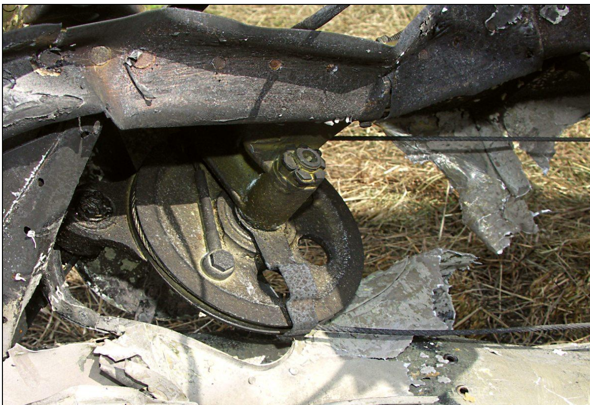
27 – Rolka linki sterowania lotkami w lewym skrzydle – zbliżenie.
