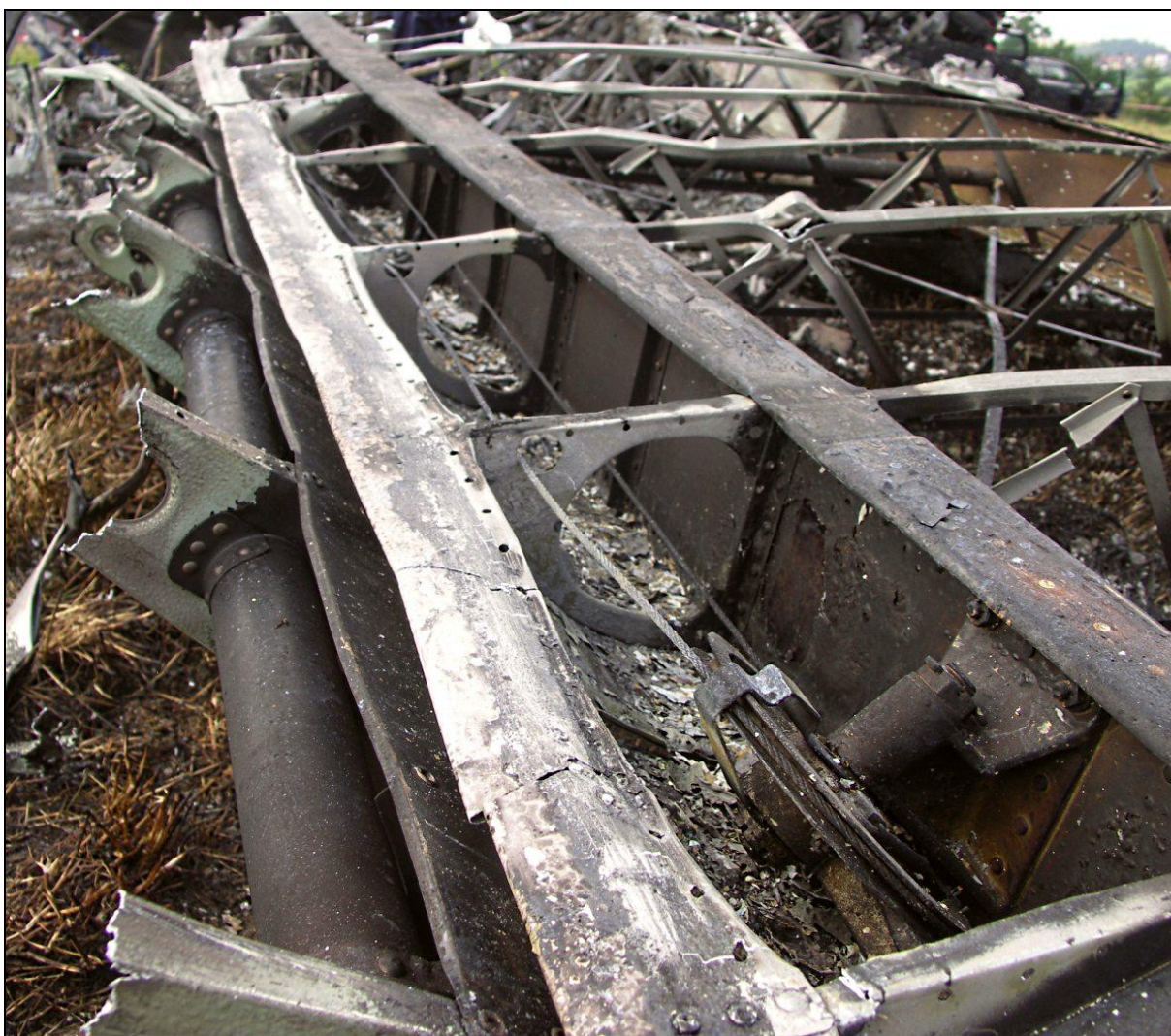
25 – Rolka linki sterowania lotkami w prawym skrzydle – widok wzdłuż tylnego dźwigara skrzydła.
