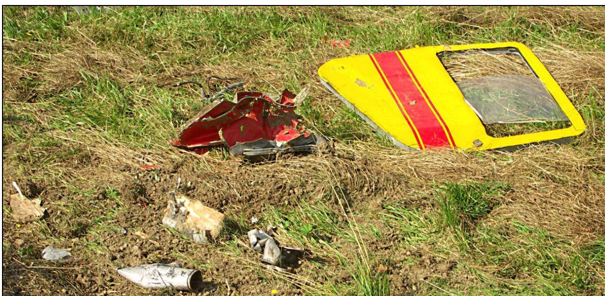
34 – Lewe drzwi kabiny i fragmenty osłon silnika.
