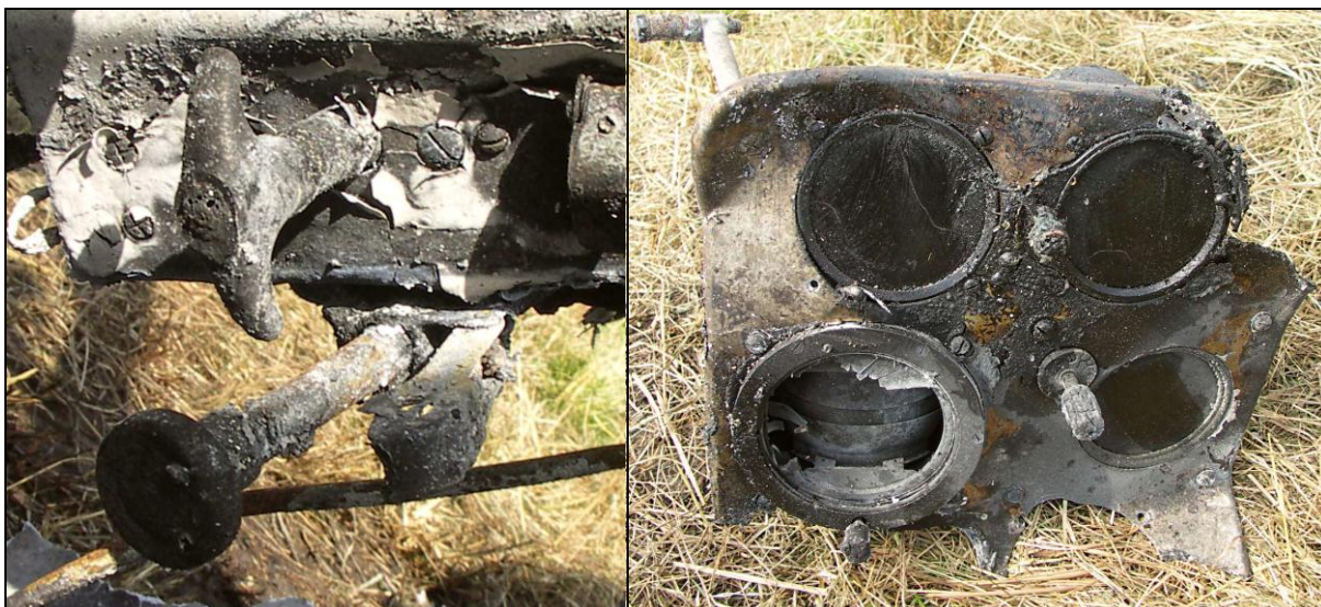
40 – Zawór paliwowy (u góry), poniżej ciągnie poprawki wysokości.
