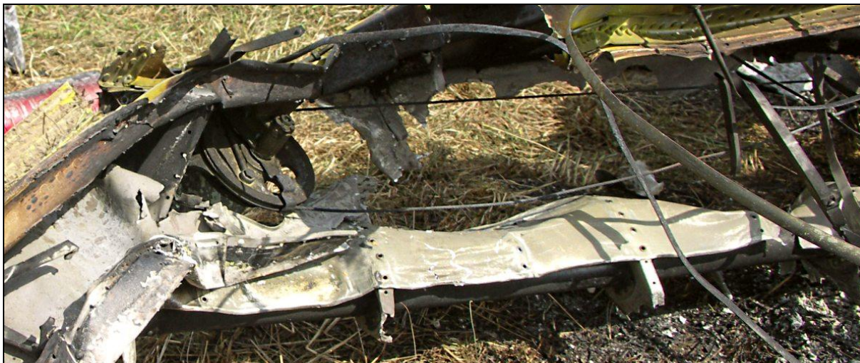
26 – Rolka linki sterowania lotkami w lewym skrzydle – zwraca uwagę skala zniszczeń.
