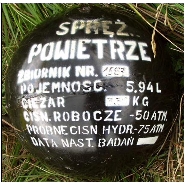
35 – Butla sprężonego powietrza z pokładowej instalacji pneumatycznej.
