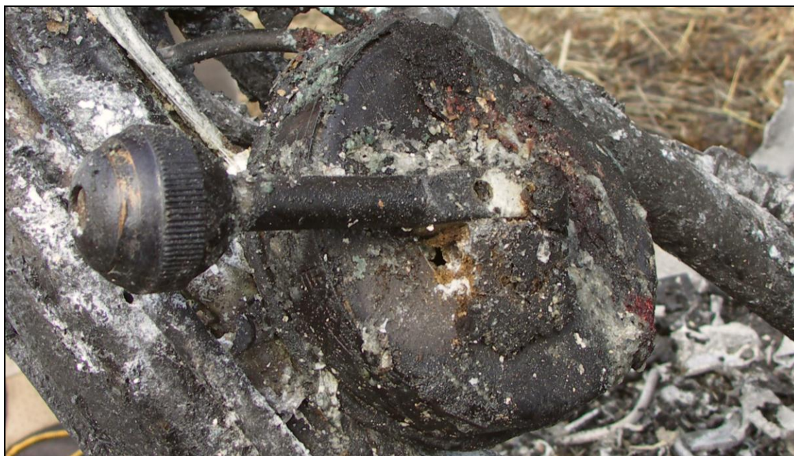
Dźwignia zaworu sterowania klapami w położeniu „schowane”.
