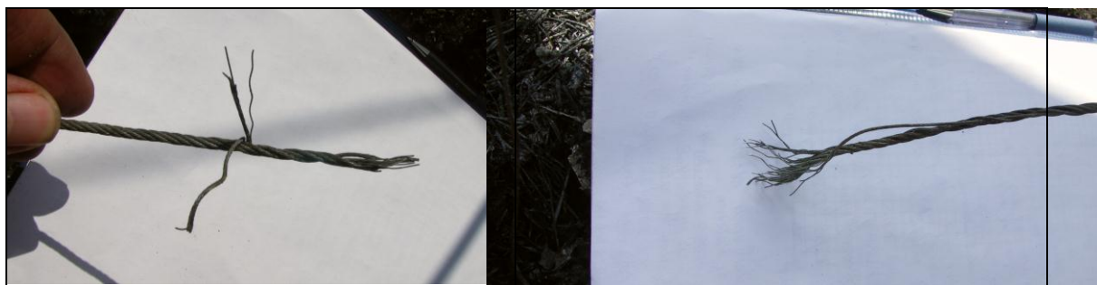
Końcówki zerwanej linki sterowania lotkami (napęd lotki lewej).
