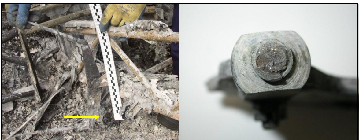
Odlamana końcówka regulacyjna popychacza steru wysokości (wskazana strzałką).
