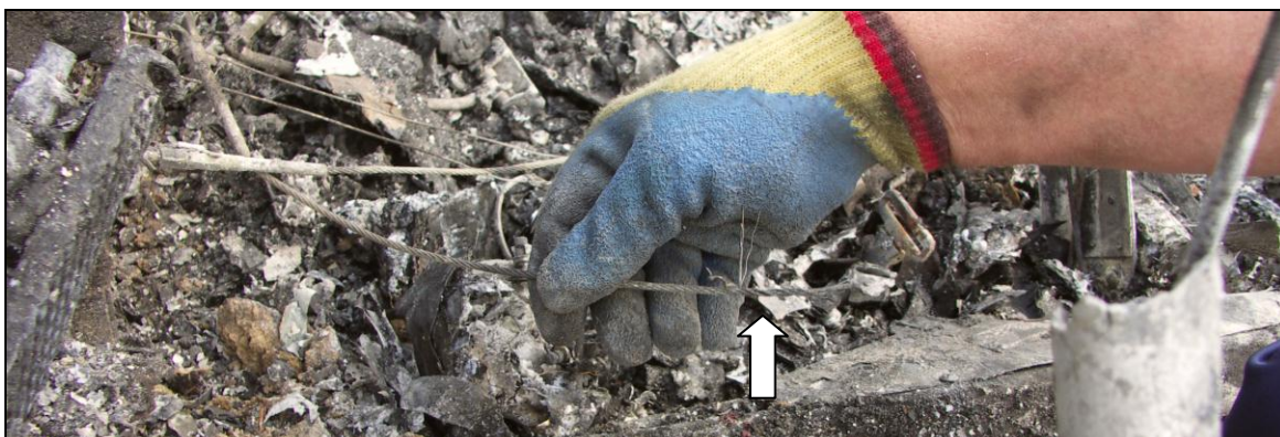
Zerwana linka napędu lotki lewej (wskazana strzałką)
