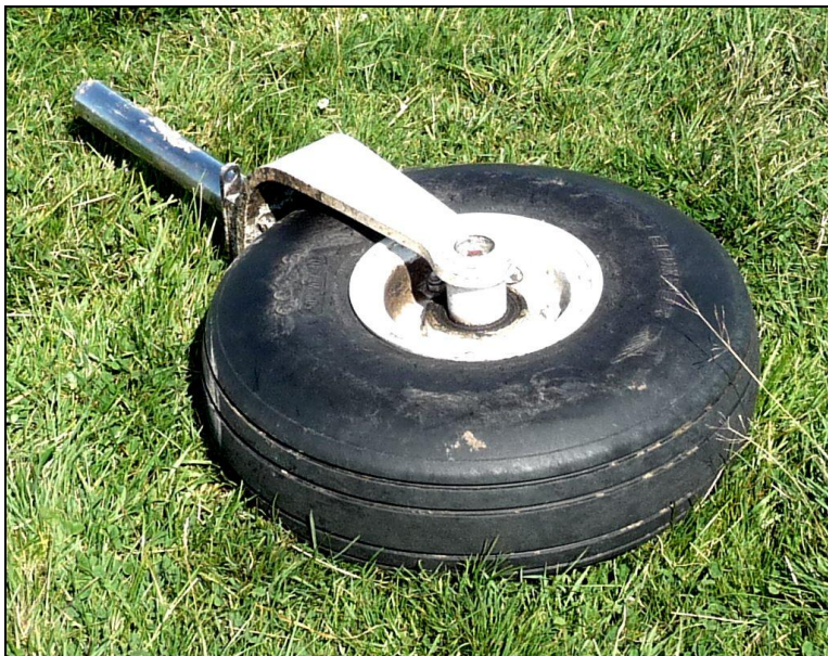
9 – Oderwany fragment podwozia przedniego z widelcem i kołem – zbliżenie [zdjęcie: użytkownik samolotu].
