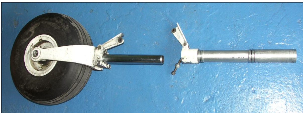
16 – Zniszczona goleń podwozia przedniego – całość po zdemontowaniu z samolotu.
