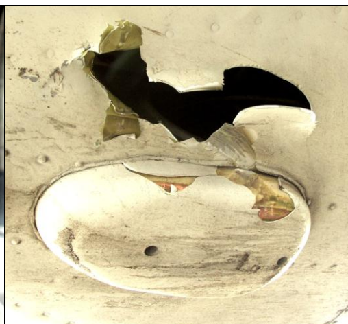
11, 12 – Przebicie dolnego pokrycia kadłuba fragmentem gołeni podwozia przedniego pokazanym na fot.[9], który trafił w samolot odbiwszy się od ziemi podczas startu.
