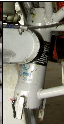
15 – Zamocowanie podwozia przedniego w łożu silnika, lewa strona, goleń zdemonstrowana.
