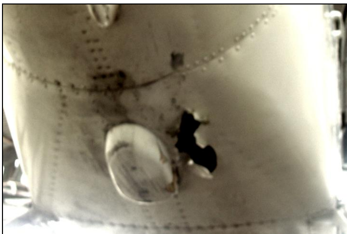
11, 12 – Przebicie dolnego pokrycia kadłuba fragmentem gołeni podwozia przedniego pokazanym na fot.[9], który trafił w samolot odbiwszy się od ziemi podczas startu.
