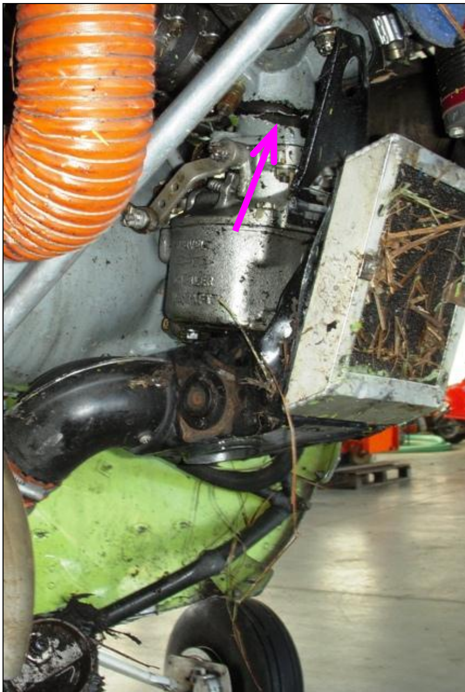
Zdj. 13. Uszkodzenia samolotu (strzałka wskazuje pęknięcie łącznika gaźnik-silnik).
