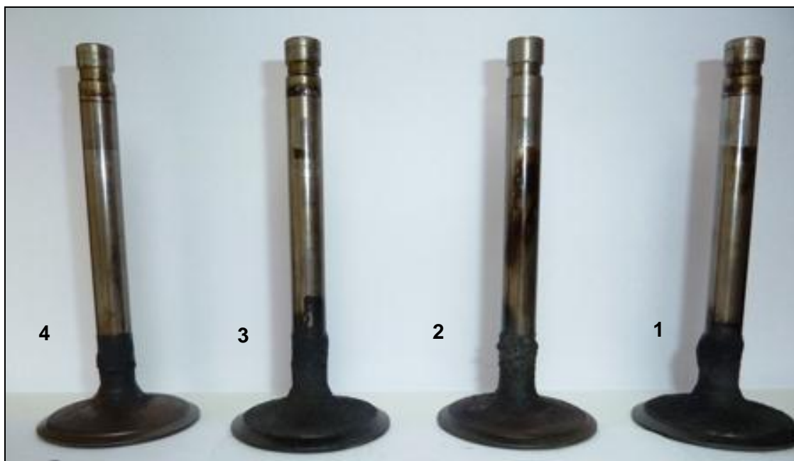
Zdj. 4. Zawory ssące. Na trzonkach zaworów cylindrów 1 i 2 widoczne nagar i przebarwienia świadczące o przedmuchu spalin.
