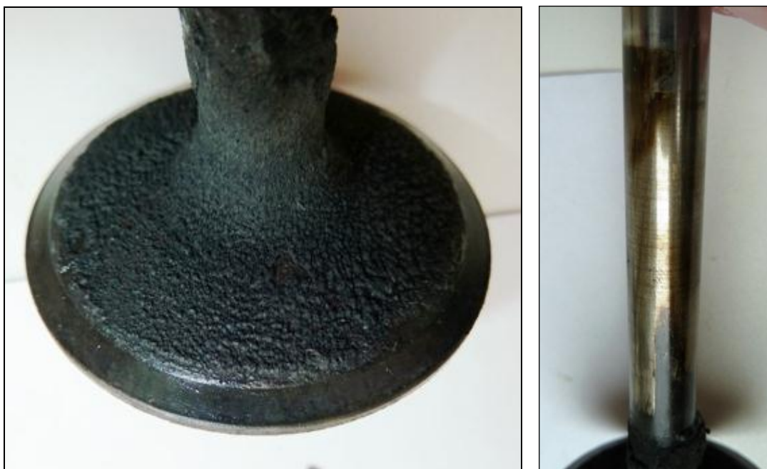
Zdj. 5. Zwór ssący cylindra nr 1. Widoczne przebarwienia na trzonku.
