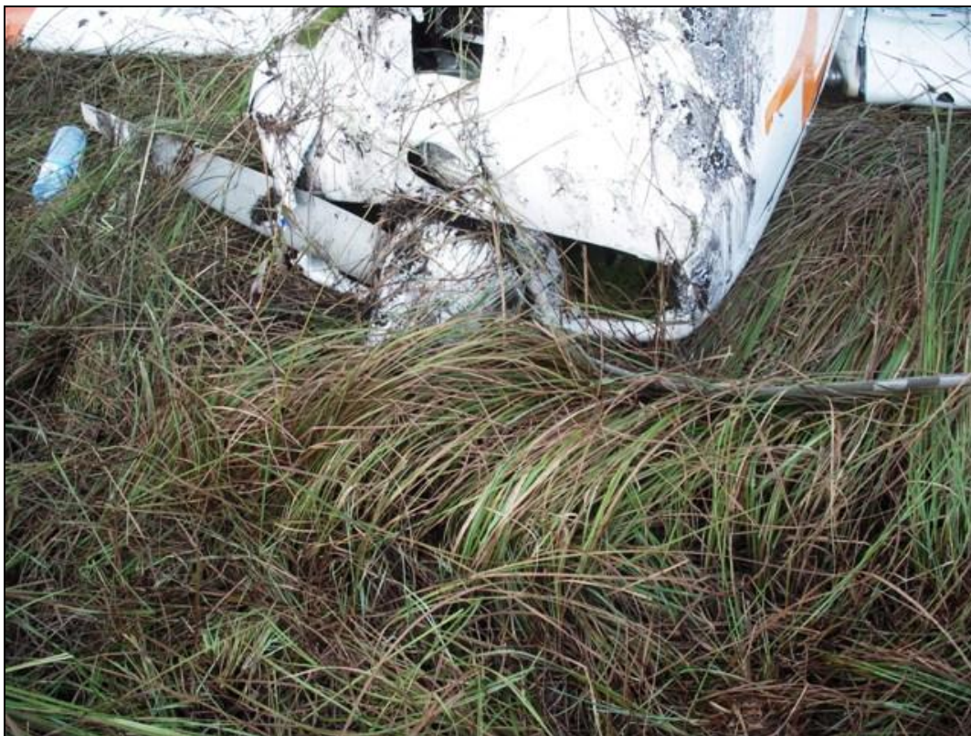
Zdj. 11. Uszkodzenia samolotu (osłony silnika, śmigło).
