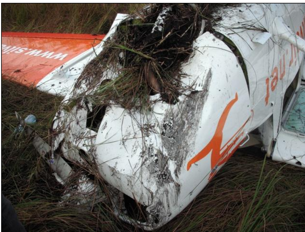
Zdj. 12. Uszkodzenia samolotu (osłony silnika, układ wydechowy, śmigło, podwozie przednie).
