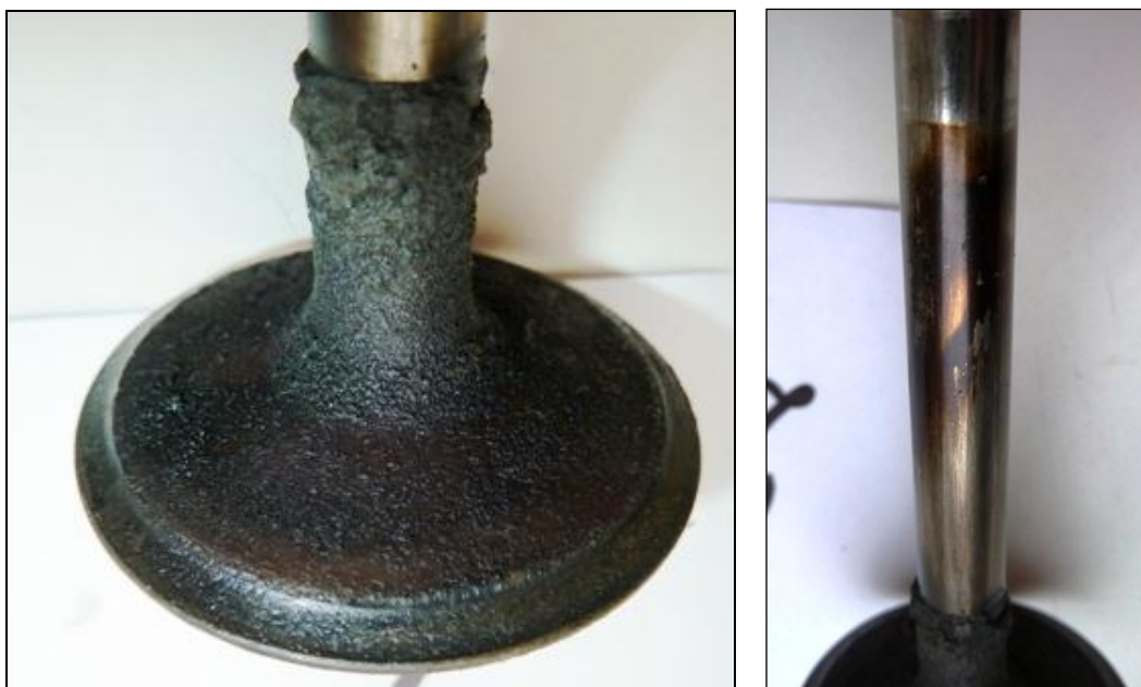
Zdj. 6. Zwór ssący cylindra nr 2. Wygląd przyłgni zaworu wskazuje na jej nieszczelność. Widoczne przebarwienia na trzonku.
