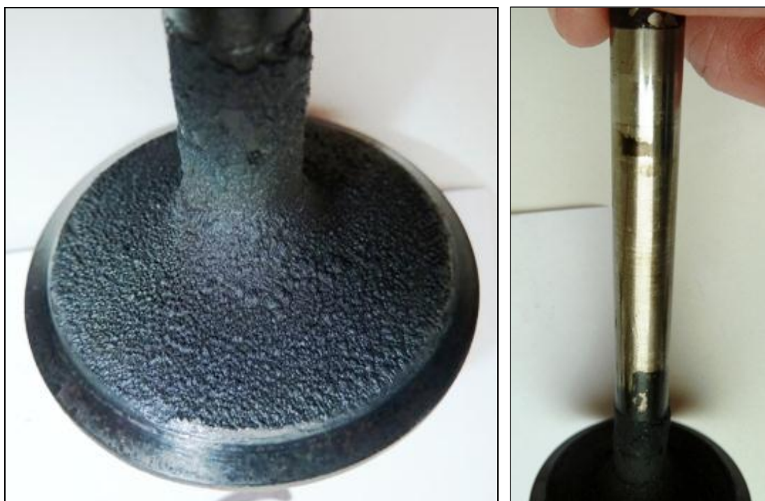
Zdj. 7. Zwór ssący cylindra nr 3. Wygląd przyłgni zaworu wskazuje na jej szczelność.
