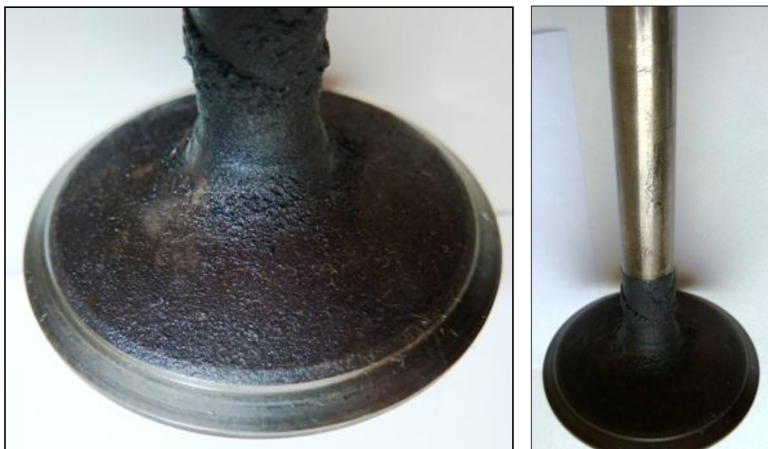
Zdj. 8. Zwór ssący cylindra nr 4. Wygląd przyłgni zaworu wskazuje na jej szczelność.
