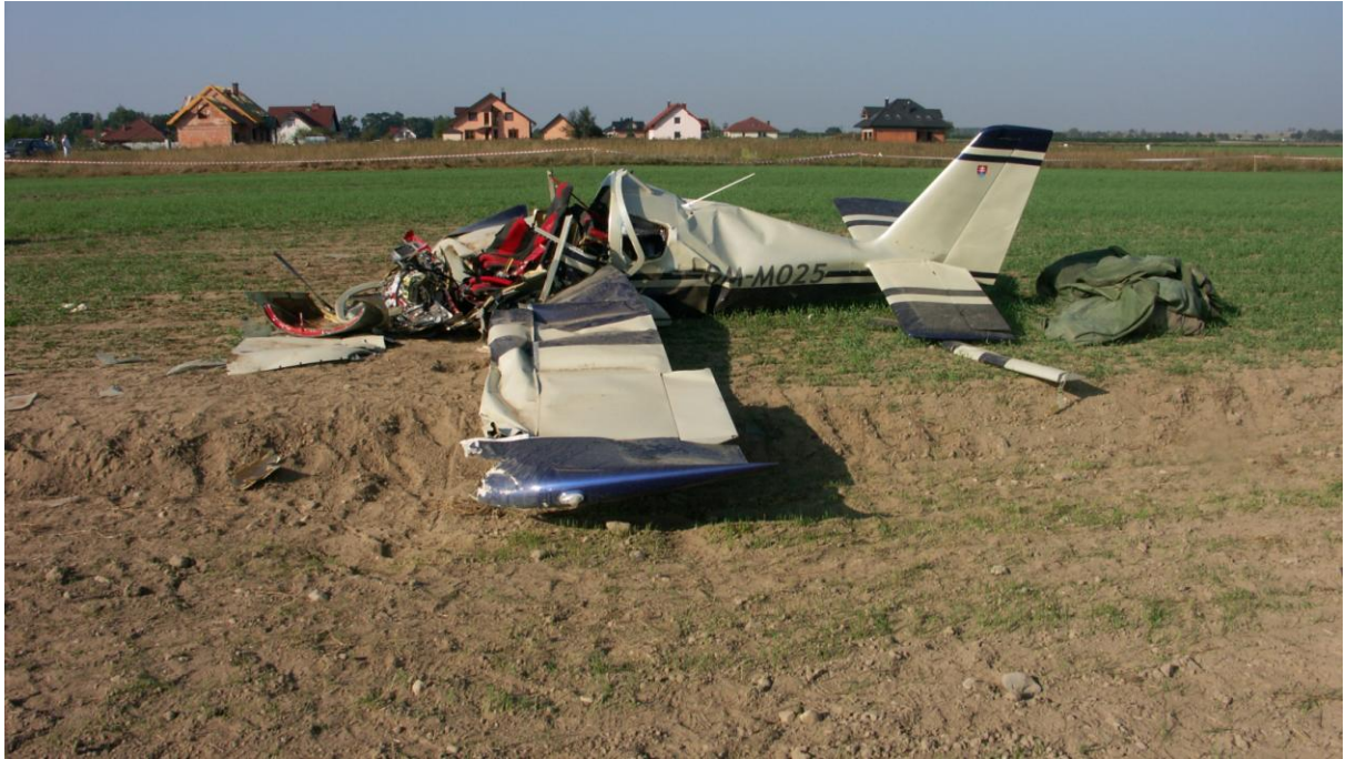
Fot. 4 Widok miejsca wypadku z boku. Brak śladów na ziemi wskazujących na stopniowe niszczenie samolotu. Tylna część konstrukcji kadłuba spęczzona bez przełamania co wyklucza zderzenie w trakcie obrotu.
