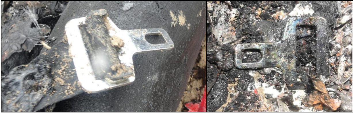
22 i 23 – Klamry pasów bezpieczeństwa. Stan, w jakim je znaleziono, świadczy o tym, że pasy bezpieczeństwa były rozpięte [foto: PKBWL, Marek Misztal].
