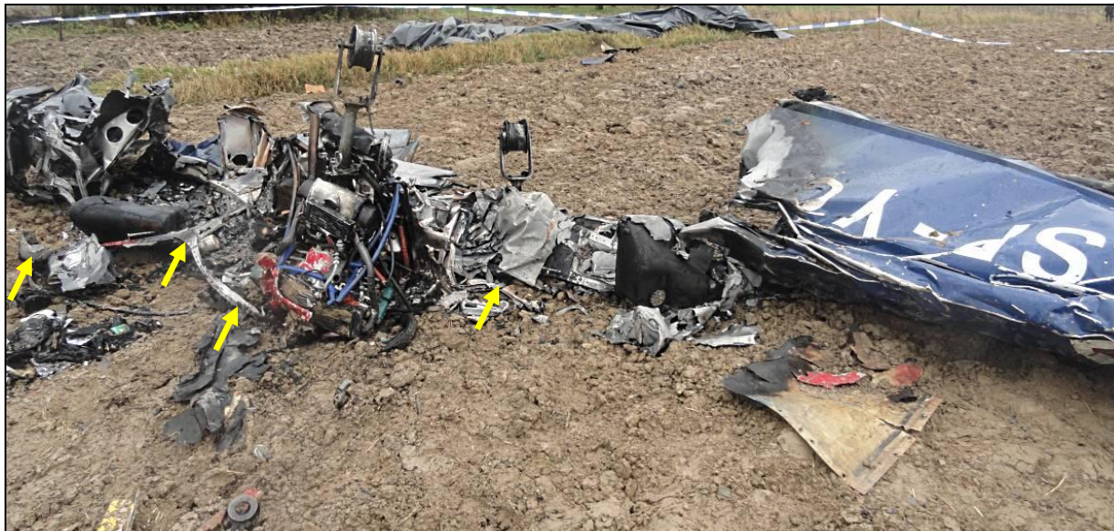
20 – Widok ogólny na wrak od przodu. Strzałkami zaznaczona zniszczona rama osłony kabiny [foto: PKBWL, Marek Misztal].
