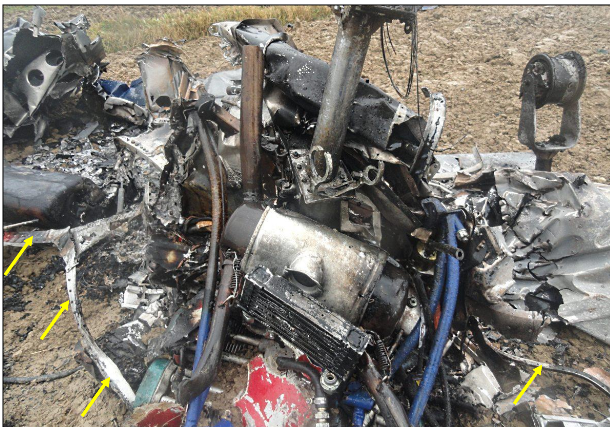
21 – Widok ogólny na wrak od przodu - zbliżenie. Strzałkami zaznaczona zniszczona rama osłony kabiny [foto: PKBWL, Marek Misztal].
