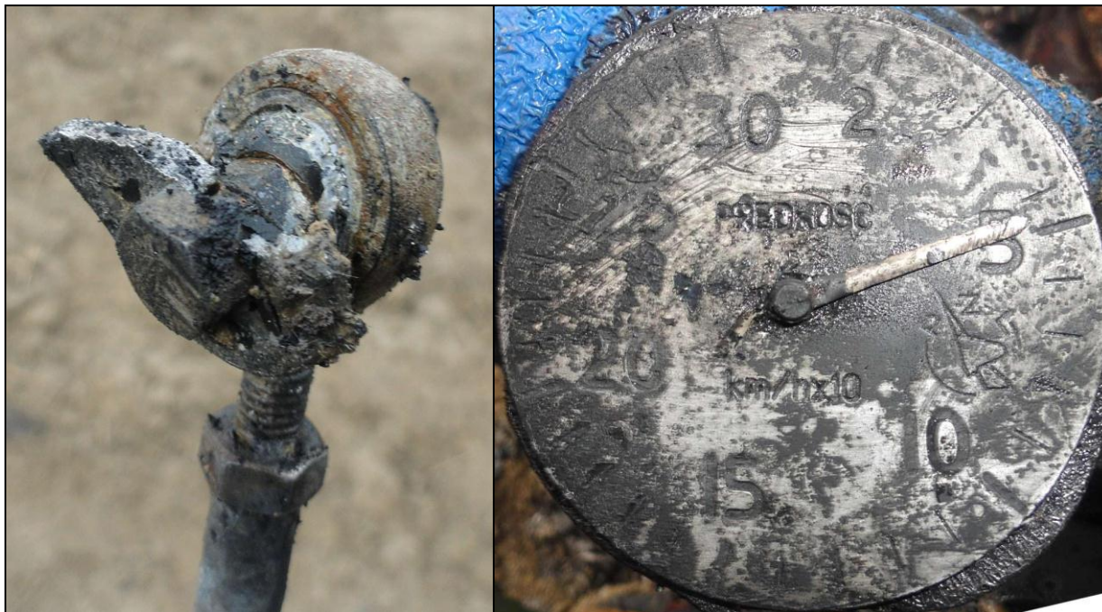
30 – Końcówka jednego z popychaczy z odłamanym fragmentem dźwigni [foto: PKBWL, Marek Misztal].
