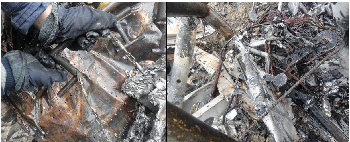
26 – Sterownice nożne z linkami sterowania [foto: PKBWL, Marek Misztal].
