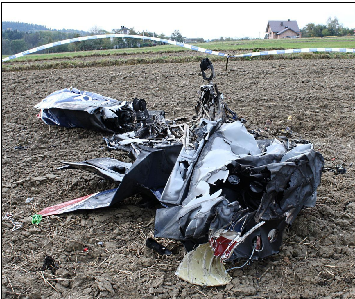
17 – Spalony wrak samolotu, widok ogólny od tyłu i od strony lewego skrzydła [foto: PKBWL, Marek Misztal].
