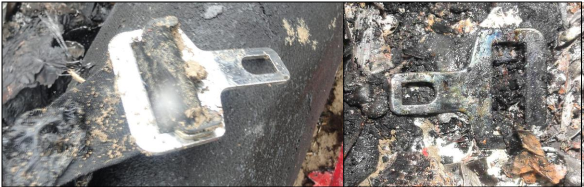
Klamry pasów bezpieczeństwa. Stan, w jakim je znaleziono, świadczy o tym, że pasy bezpieczeństwa były rozpięte [foto: PKBWL, Marek Misztal].
