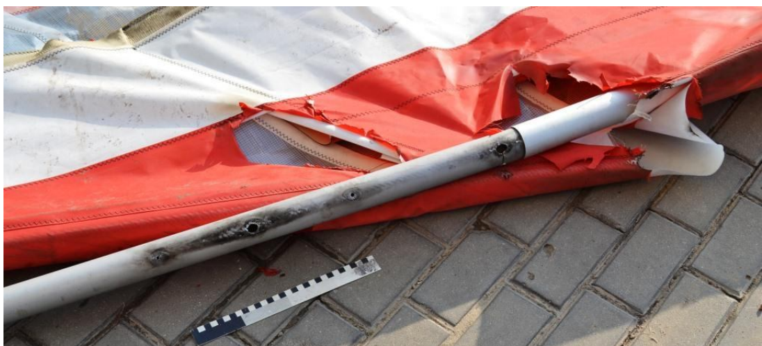
Fot. 2. Widok lewej krawędzi natarcia z widocznymi uszkodzeniami powstałymi po kontakcie z linią elektryczną. Fot. PKBWL.
