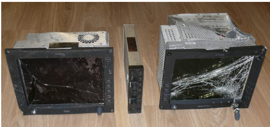
Rys.6. Uszkodzone wyświetlacze MFD i PFD oraz panel autopilota zdemontowane z wraku samolotu SP-IKP.
