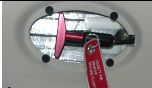
Rys.11a. Prawidłowo zabezpieczony przed przypadkowym użyciem system ratowniczy. Zdjęcie wykonane na bliźniaczym egzemplarzu samolotu Cirrus SR22.
