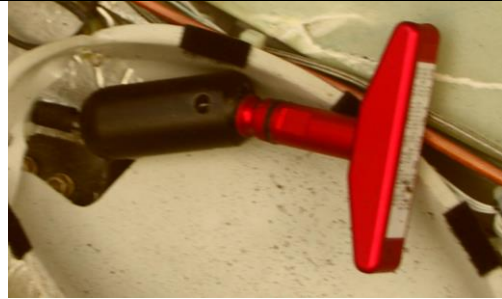
Rys.11. Uchwyt uruchamiający system ratowniczy w „kieszeni” pod sufitem kabiny. Zdjęcie wykonane na miejscu wypadku.
