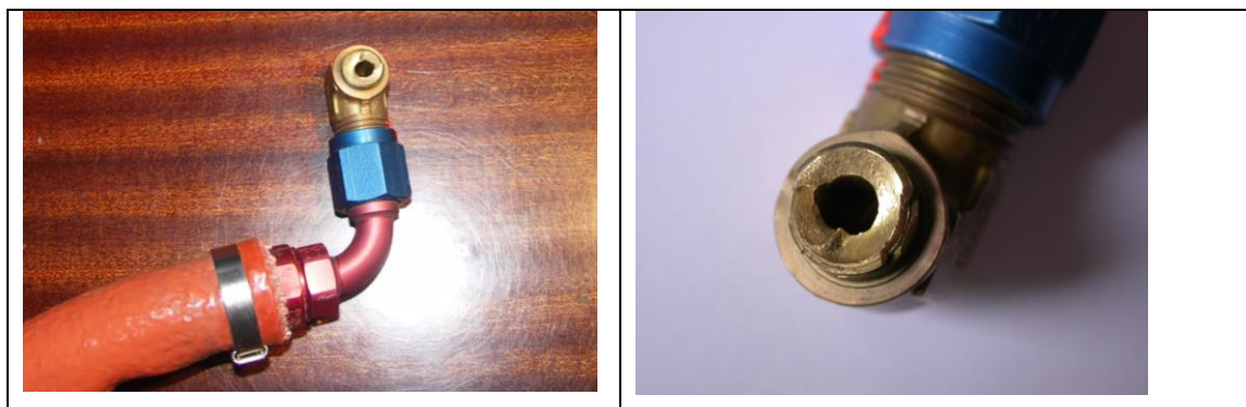
Rys.12. Kolanko z zespołu pompy paliwowej wraz z elastycznym przewodem paliwowym oraz przekrój przełomu zmęczeniowego.
