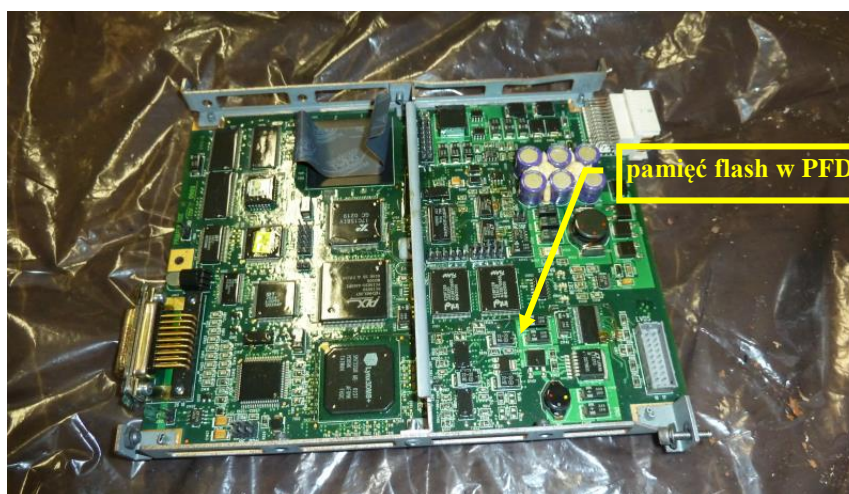
Rys.9. Pamięć flash na płycie drukowanej wyświetlacza PFD.
