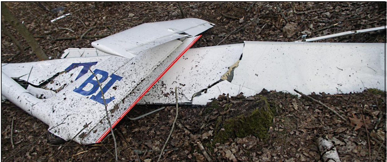
12 – Rozbity szybowiec – odłamana belka kadłuba z usterzeniem i prawe skrzydło; widok od przodu.
