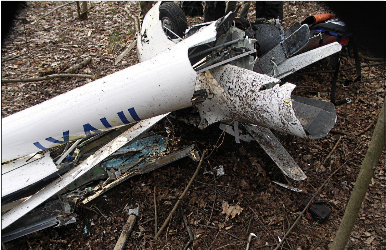
19 – Rozbity szybowiec – fragment odłamanej belki ogonowej, nasadowa część prawego skrzydła i środkowa część kadłuba; widok od tyłu.
