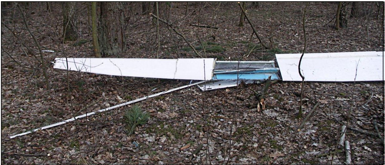
8 – Rozbity szybowiec – lewe skrzydło w rejonie końcówki, widok od przodu.
