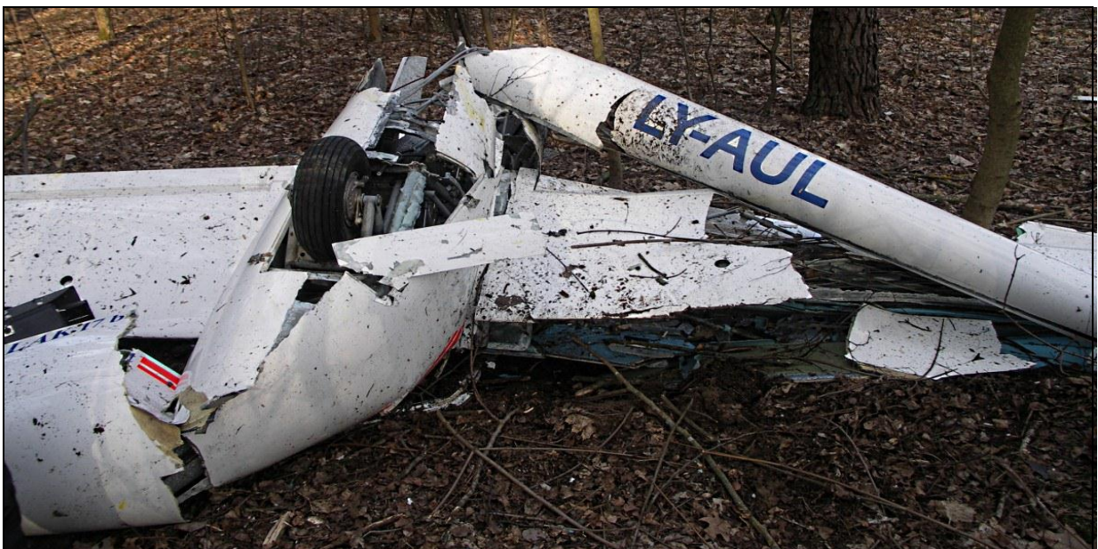
10 – Rozbity szybowiec – przednia część kadłuba z kabiną, widoczne nasadowe części skrzydeł i odłamana belka kadłuba; widok od przodu. Zwraca uwagę wypuszczone podwozie.
