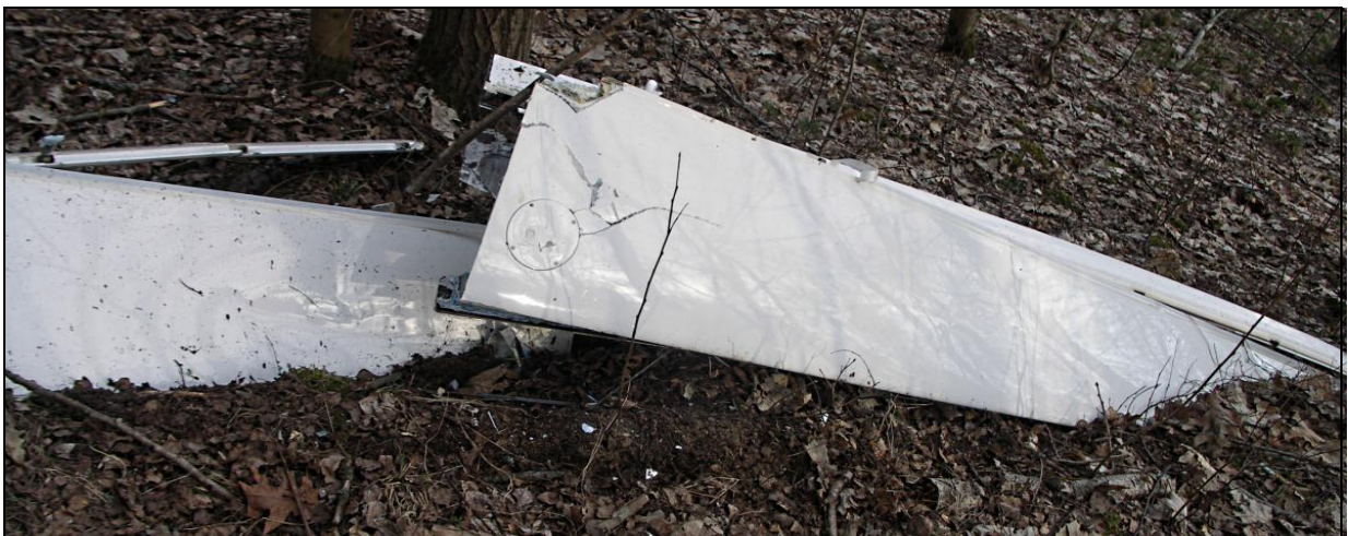
13 – Rozbity szybowiec – zniszczone prawe skrzydło na połączeniu segmentów; widok od przodu. Zakończenie środkowego segmentu wbite głęboko w ziemię (strzałka).
