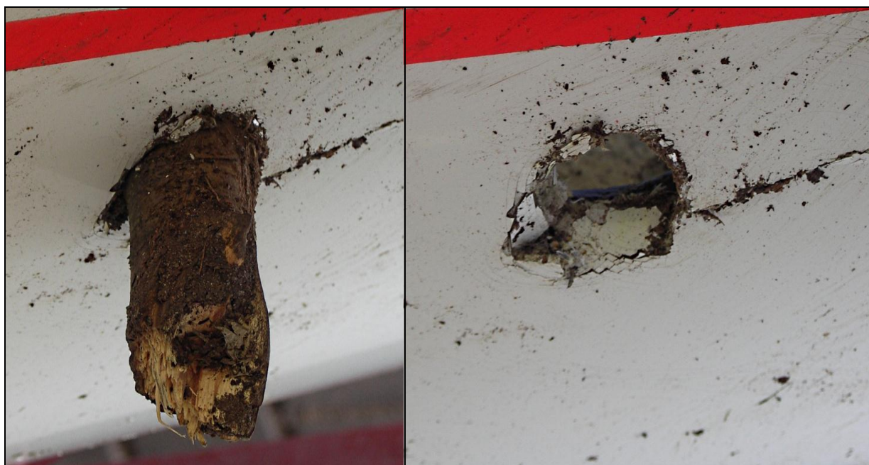
37, 38 – Przebicie skorupy pokrycia po prawej stronie kabiny przez fragment gałęzi drzewa.
