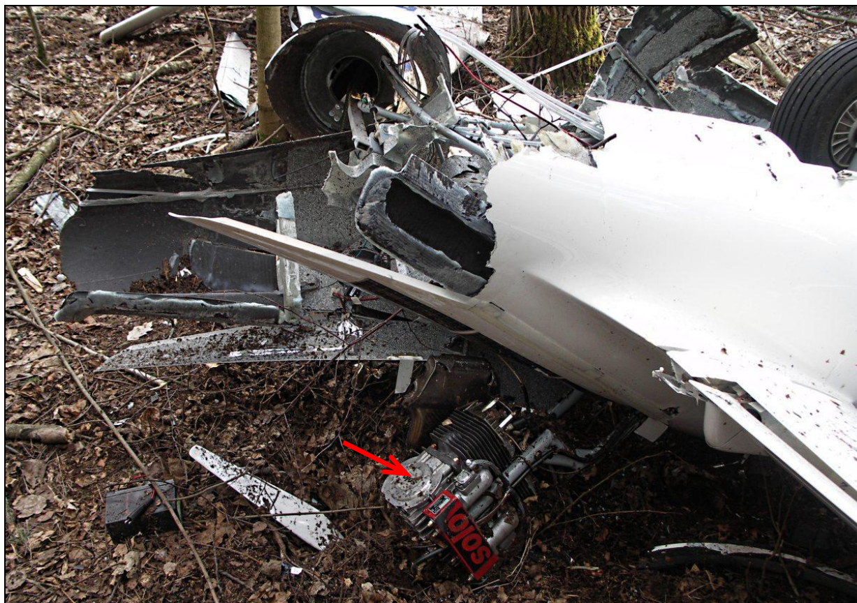
21 – Rozbity szybowiec – środkowa część kadłuba; widok z lewej strony. Strzałką wskazany silnik.
