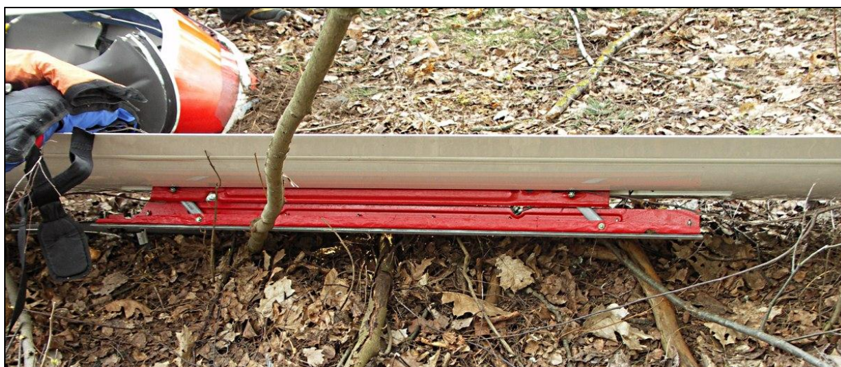
22 – Rozbity szybowiec – lewe skrzydło w rejonie hamulca aerodynamicznego; widok od tyłu. Zwraca uwagę położenie hamulca.
