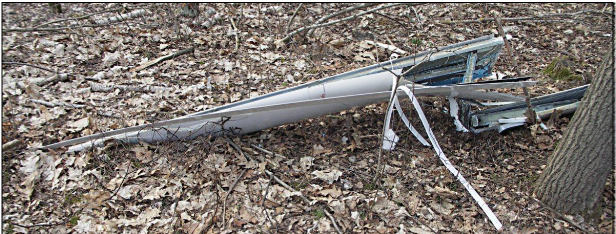
15 – Rozbity szybowiec – końcowy segment prawego skrzydła; widok od tyłu.
