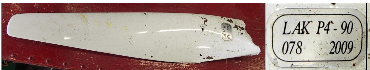
31, 32 – Odłamana łopata śmigła i oznaczenia wytwórcy na łopacie.
