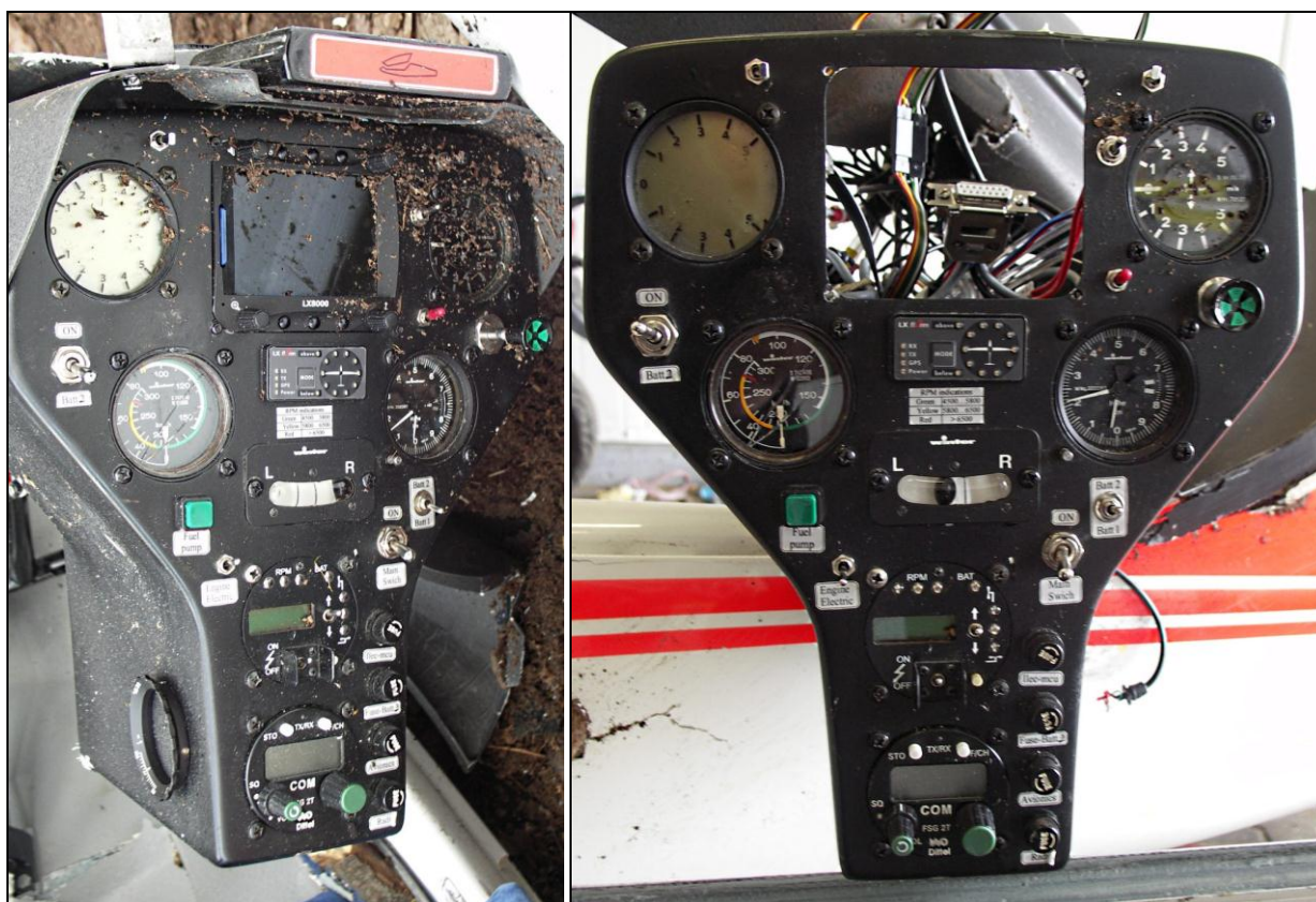
24, 25 – Tablica przyrządów – z lewej na miejscu wypadku, z prawej po częściowym demontażu.
