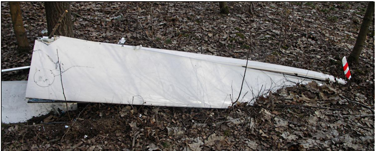
14 – Rozbity szybowiec – końcowy segment prawego skrzydła; widok od przodu. Końcówka segmentu zewnętrznego wbita głęboko w ziemię (strzałka).
