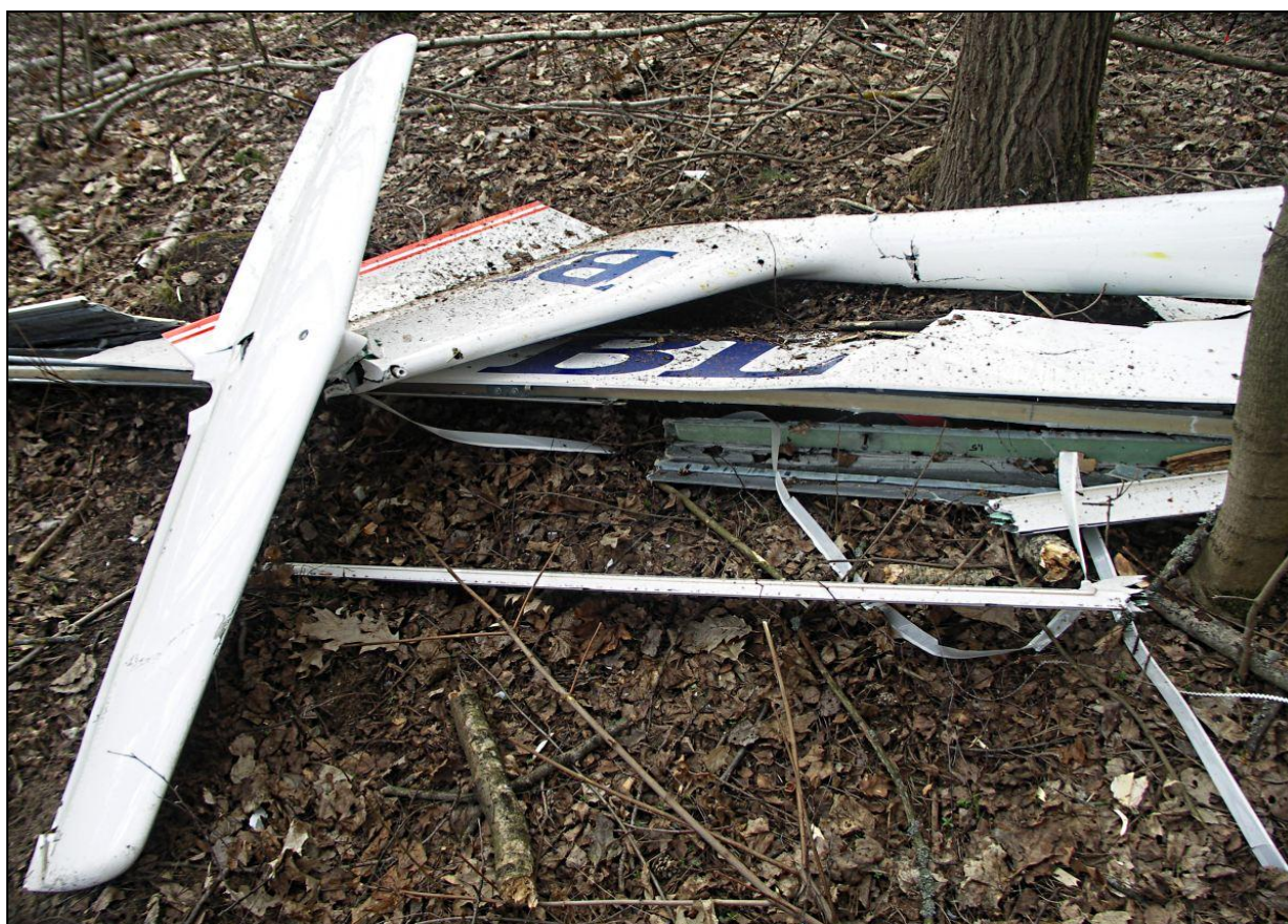
18 – Rozbity szybowiec – odłamana belka kadłuba z usterzeniem i prawe skrzydło; widok od tyłu.
