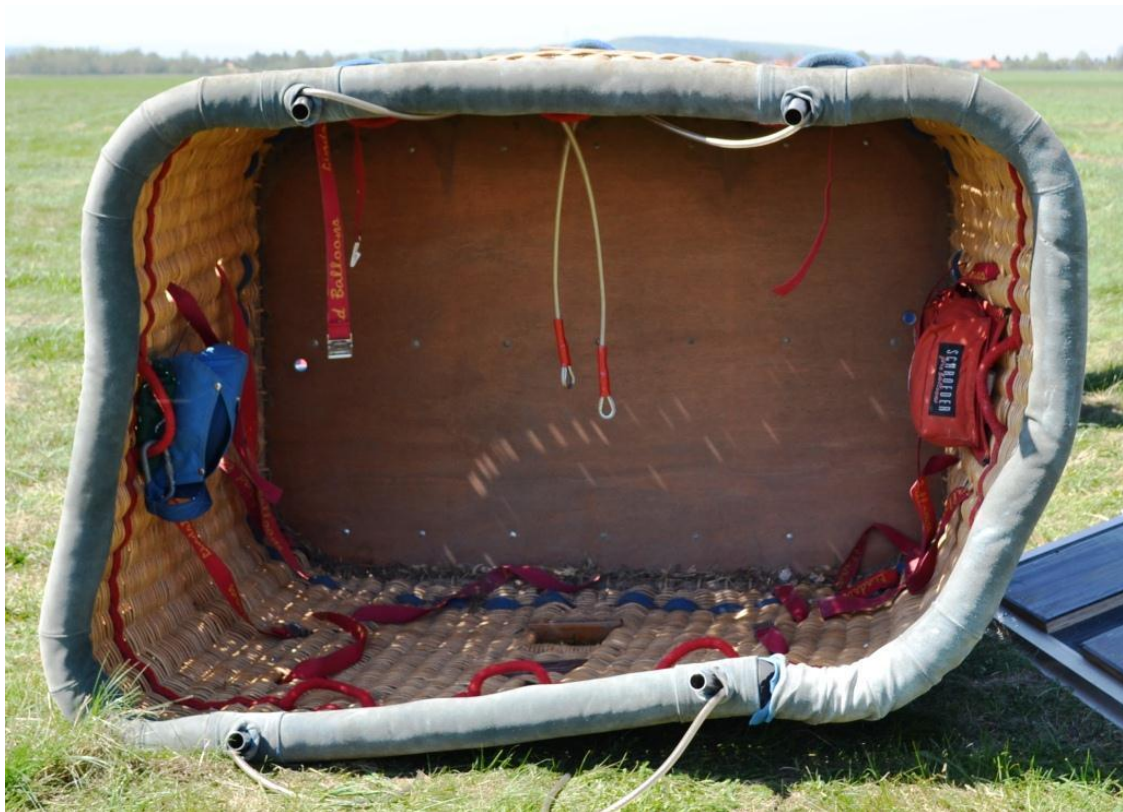
Fot. 3. Widoczna deformacja kosza, wskazująca na znaczne uszkodzenie konstrukcji – złamanie górnej ramy kosza. Fot. PKBWL.
