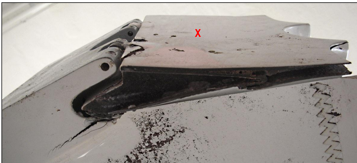
24 – Widok z lewej strony na środkowy segment steru wysokości [X], zamocowany na stateczniku pionowym.
