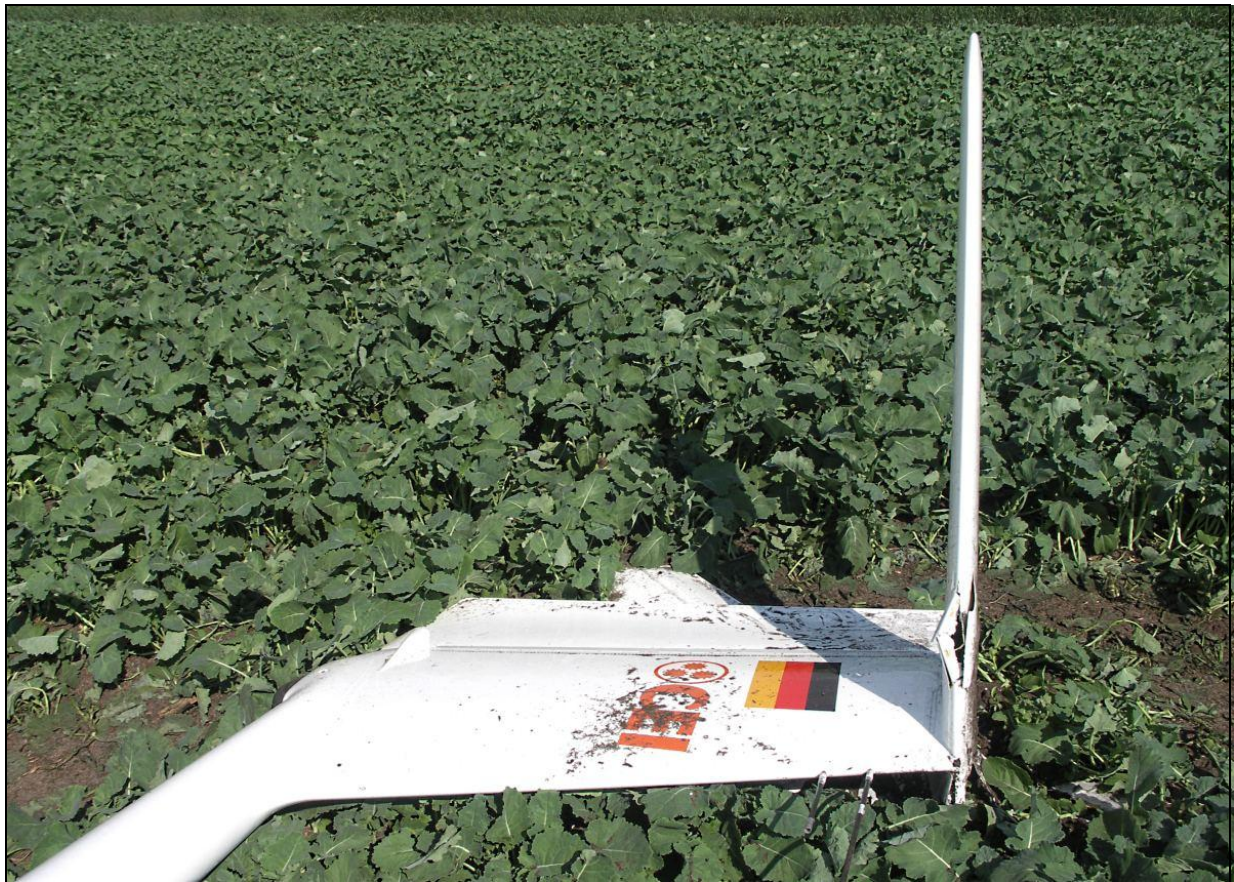
16 – Usterzenie pionowe, widoczne odłamanie lewej połowki statecznika poziomego.
