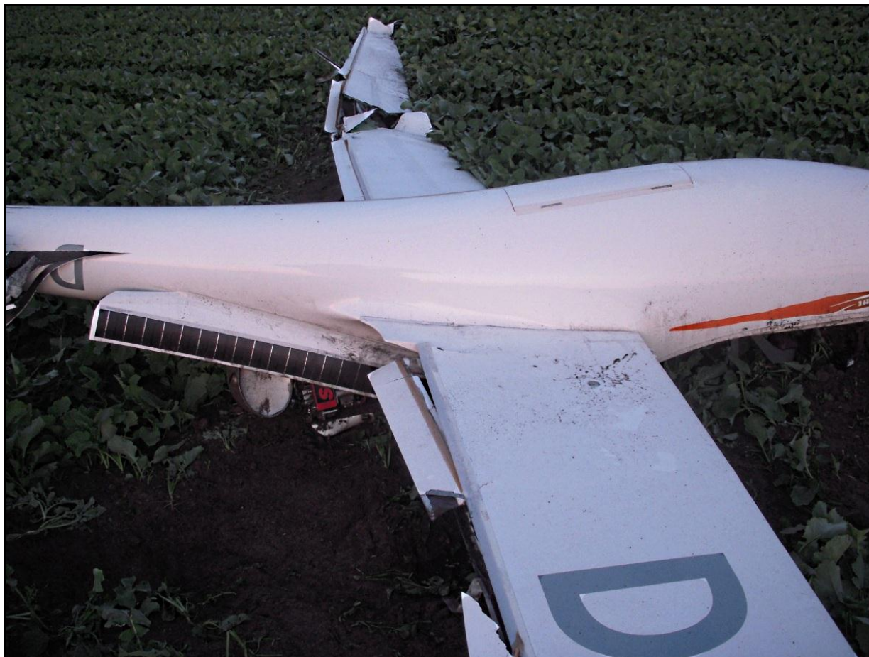
7 – Środkowa część kadłuba – widoczne otwarte pokrywy zespołu napędowego i częściowo wysunięty wskutek uderzenia o ziemię zespół napędowy.
