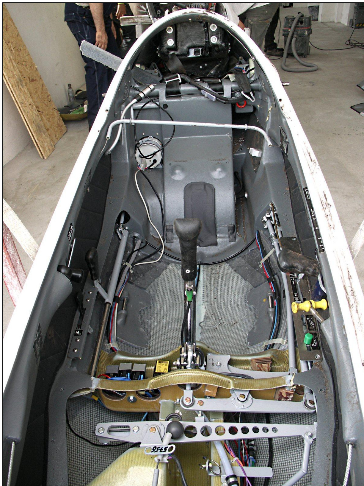
34 – Widok na tylną część kabiny. Widoczne węzły i elementy układów sterowania.
