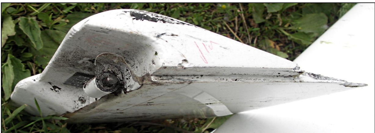
22 – Widok od strony płaszczyzny symetrii szybowca na zakończenie odłamanego fragmentu lewego segmentu steru wysokości z żeberkiem sprzęgającym go ze środkowym segmentem. Dobrze widoczny zawias segmentu steru wysokości.
