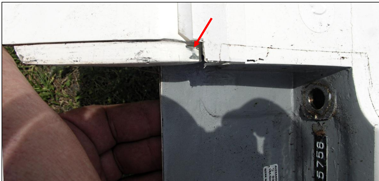
23 – Widok z dołu na środkową część usterzenia poziomego. Widoczne zakończenie prawego segmentu steru wysokości z żeberkiem sprzęgającym go ze środkowym segmentem. Strzałką wskazane ślady ocierania części.
