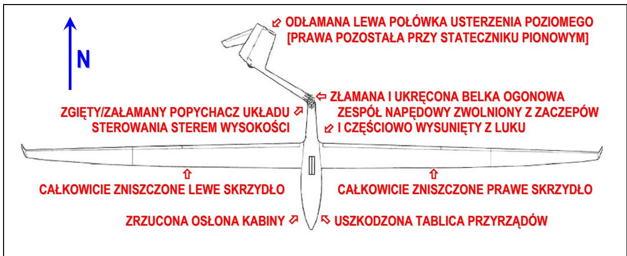
4 – Szkic usytuowania szybowca na miejscu wypadku i jego zasadniczych uszkodzeń.
