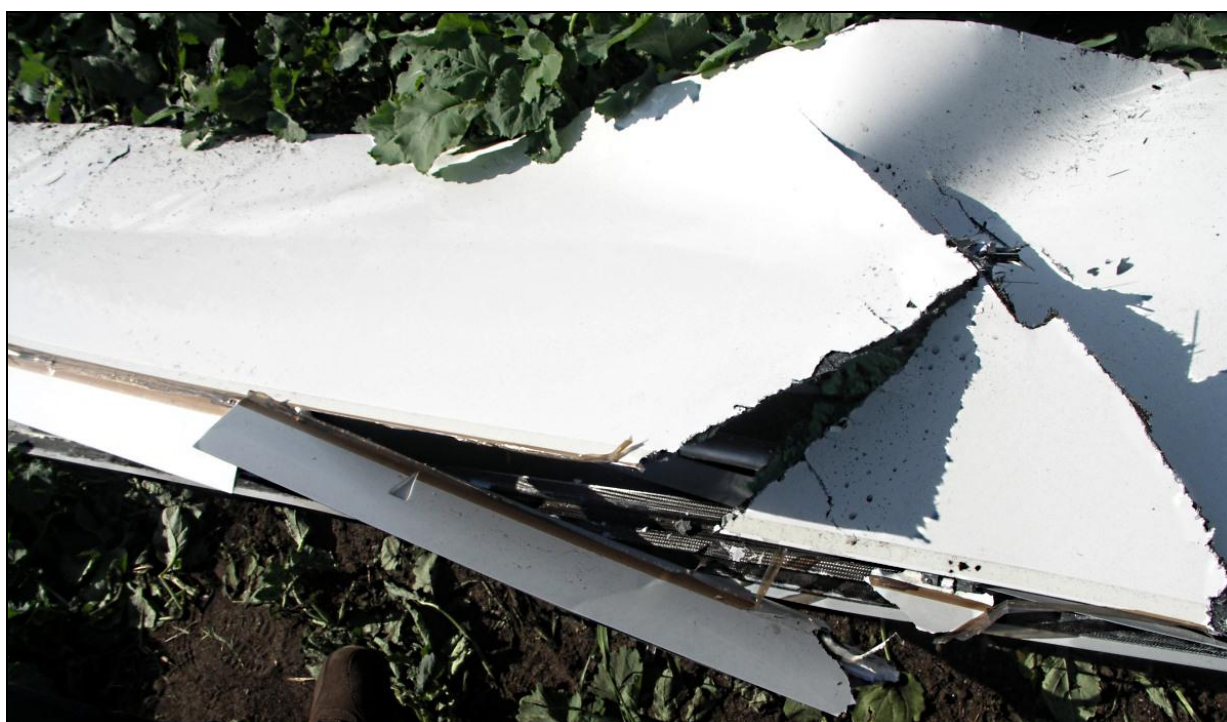
15 – Zbliżenie na miejsce uszkodzenia prawego skrzydła.
