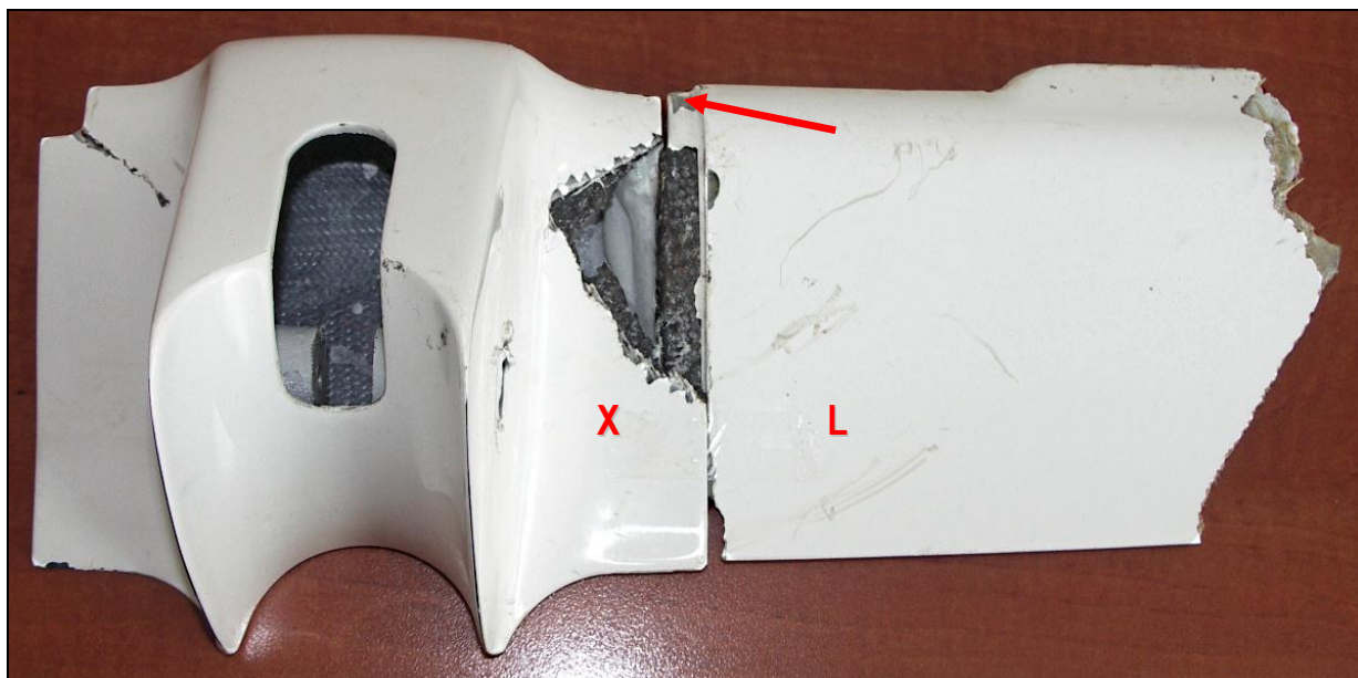
27 – Zdemontowane z szybowca, uszkodzone: środkowy segment steru wysokości [X] i fragment lewego segmentu steru wysokości [L], widok od dołu. Strzałką wskazane ślady ocierania części.
