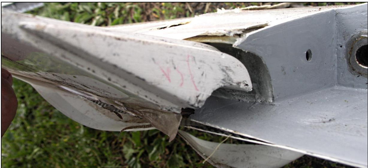
21 – Widok od strony płaszczyzny symetrii szybowca na środkową część usterzenia poziomego. Widoczne zakończenie prawego segmentu steru wysokości z żeberkiem sprzęgającym go ze środkowym segmentem.
