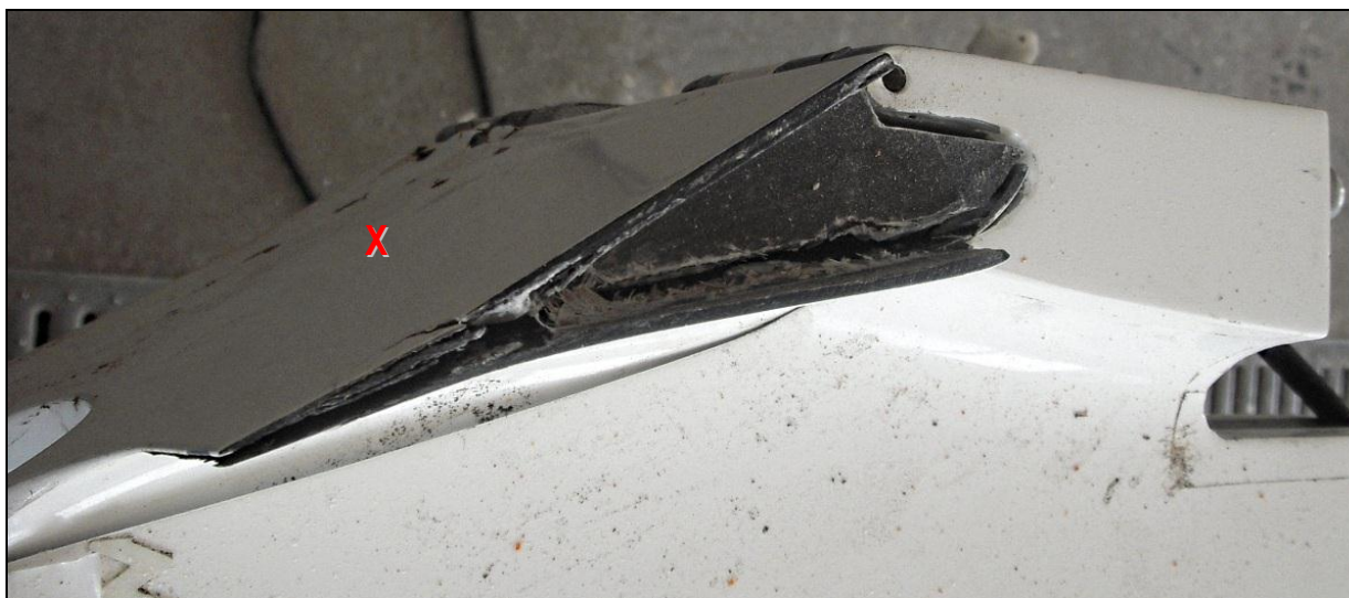
25 – Widok z prawej strony na środkowy segment steru wysokości [X], zamocowany na stateczniku pionowym.
