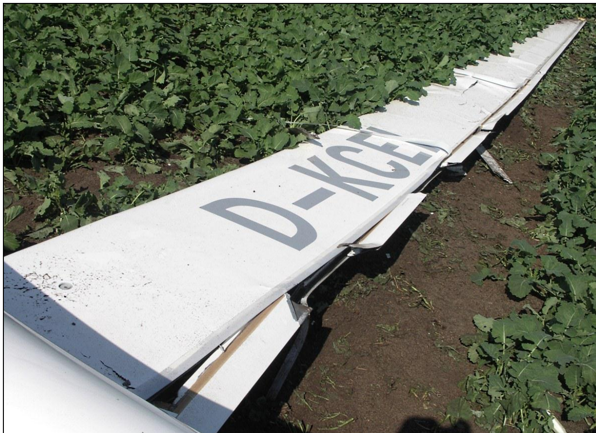
14 – Widok na zniszczone lewe skrzydło.
