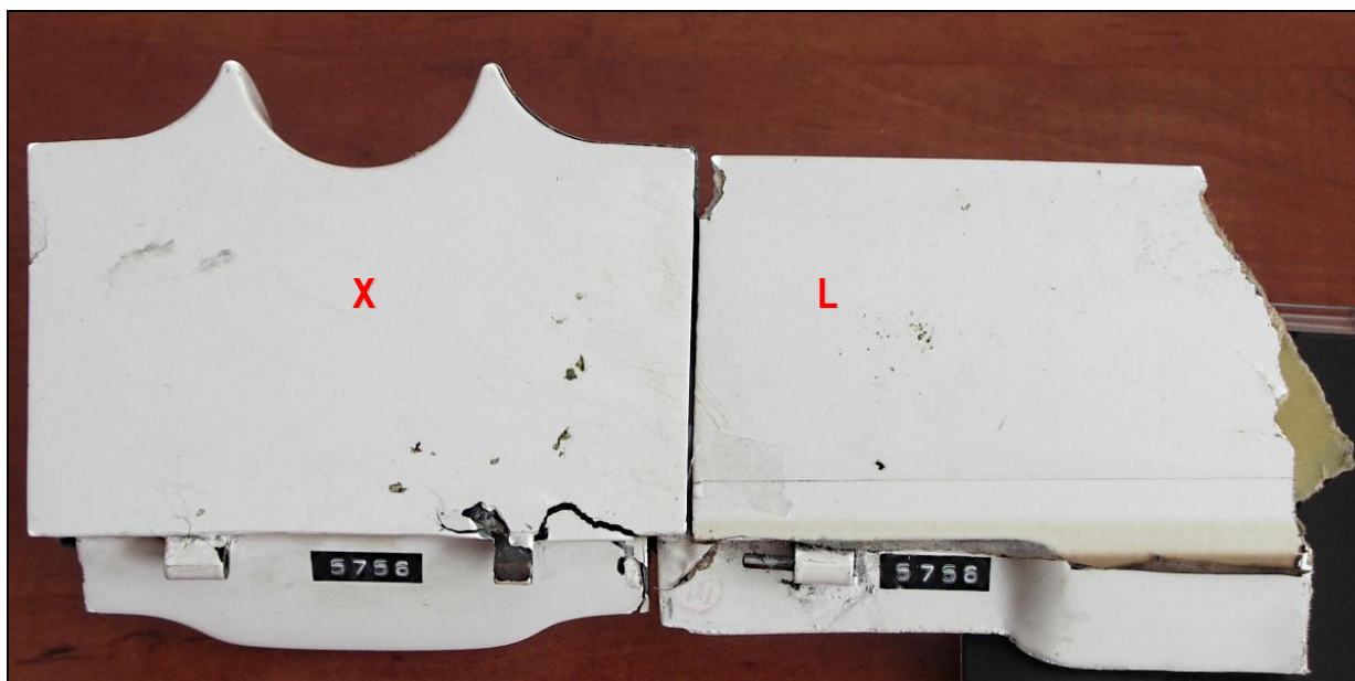
26 – Zdemontowane z szybowca, uszkodzone: środkowy segment steru wysokości [X] i fragment lewego segmentu steru wysokości [L], widok od góry.
