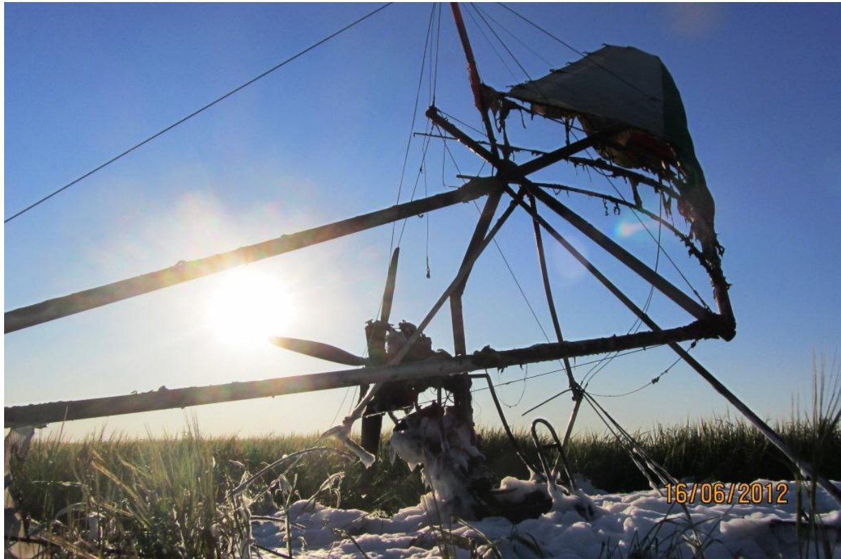
Fot.4. Widok motolotni po pożarze. Wrak motolotni pokryty środkiem gaśniczym. Autor: pilot motolotni.
