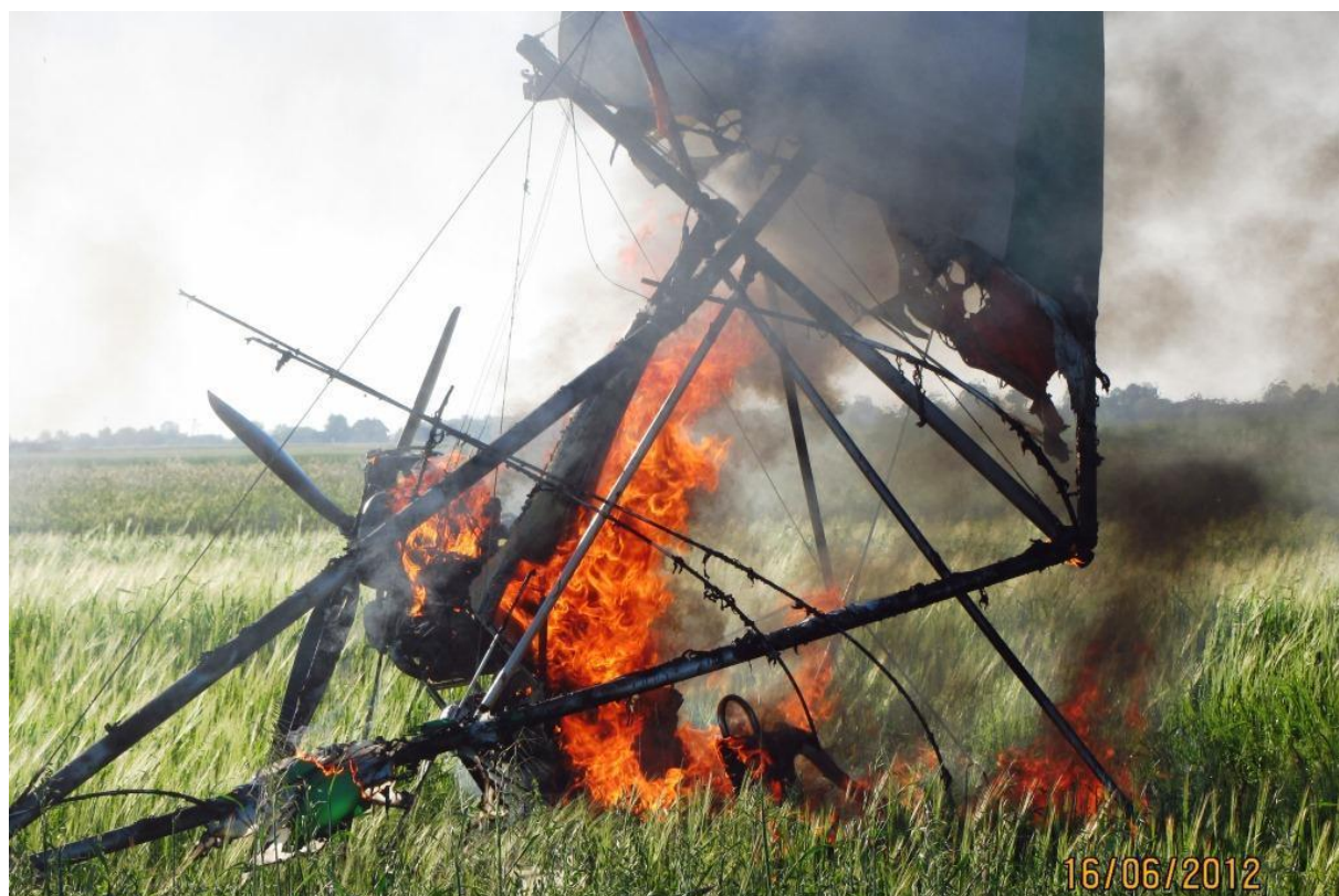
Fot.3. Rozwój pożaru motolotni – po częściowym spaleniu pokrycia wózka i laminatu wózka. Autor: pilot motolotni.
