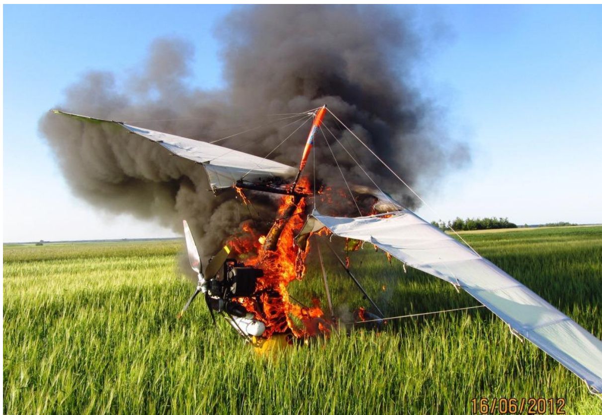
Fot.2. Rozwój pożaru motolotni – płomieniami objęte zostało skrzydło i przednia część wózka. Autor: pilot motolotni.
