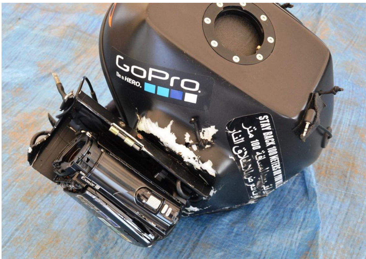
Fot.4. Widok uszkodzonej obudowy kamery Sony. Obudowa była zamykana pokrywą, do której od góry przymocowana była kamera GoPro. Fot PKBWL.
