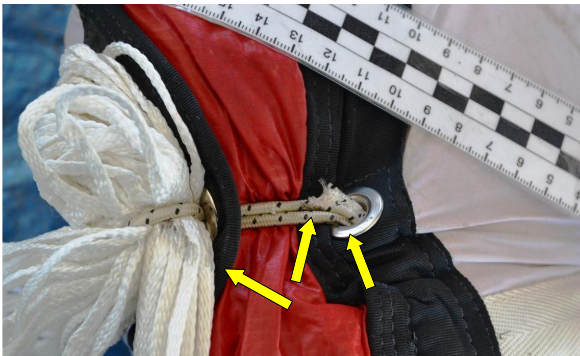
Fot. 1. Żółte strzałki wskazują czarne ślady z naniesionym obcym materiałem podobnym do pokrycia obudowy kamery. Fot. PKBWL.
