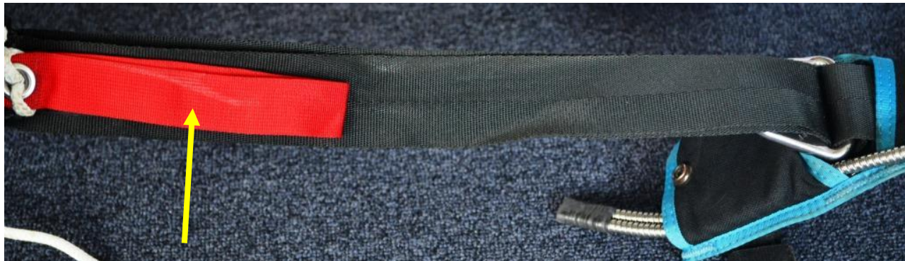
Fot.1. Widok tylnej części prawej taśmy nośnej z widocznym śladem zatopienia na tylnej części uchwytu sterowniczego. (fot PKBWL)
