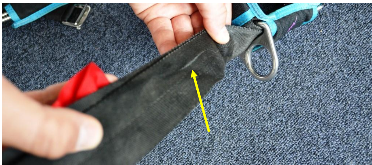
Fot 3. Widok przedniej części lewej taśmy nośnej. Widoczny ślad zatopienia. (fot PKBWL)
